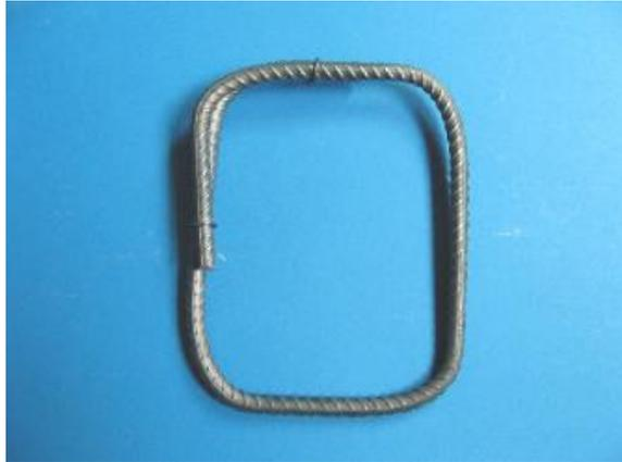
Abbildung 41: Bügelbewehrung (geschlossener Bügel) [19]
