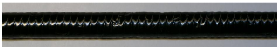
*Abbildung 14: CFK-45°-Probe mit Überdeckung = 1,0*
