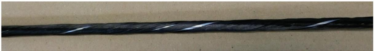
*Abbildung 12: Möglicher Wickelfehler*
