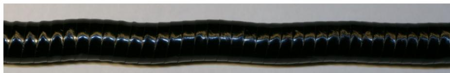
*Abbildung 13: CFK-45°-Probe mit Überdeckung = 1,2*
