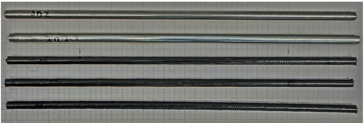
*Abbildung 38: Optischer Vergleich zwischen den Rohren nach Biegebelastung; von oben nach unten: Stahl, Aluminium, CFK 15°, CFK 30°, CFK 45°*
