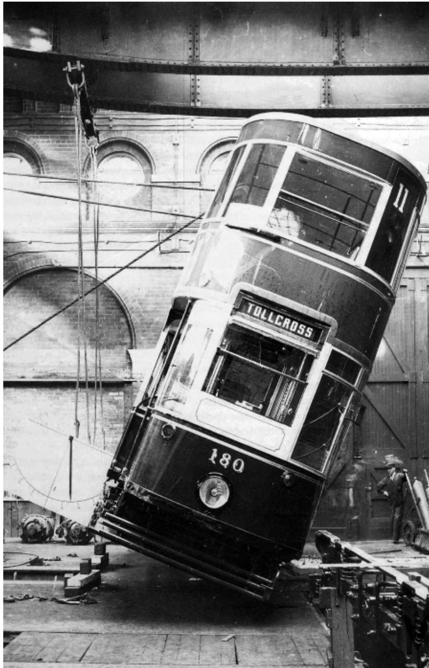
Abb. 61: Schwenkungstest (oben links)
