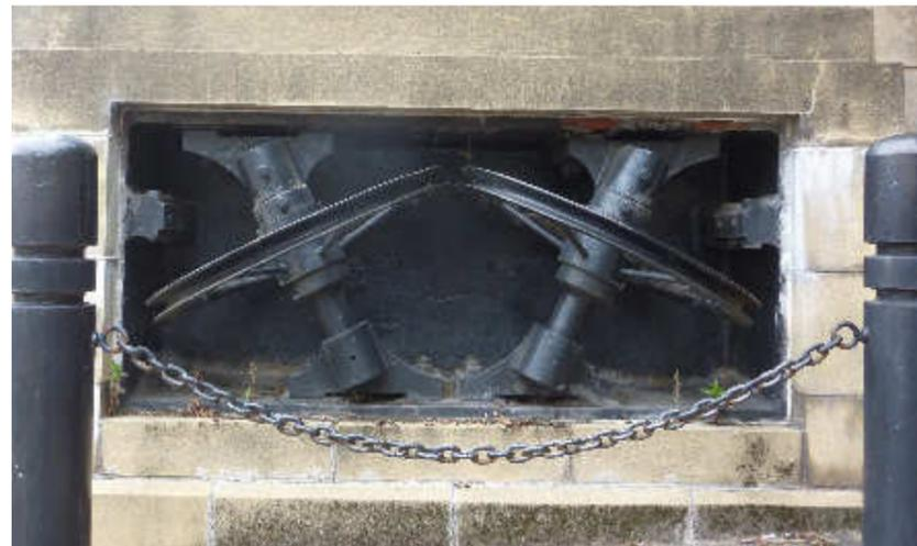
Abb. 17: Diese Riemenscheiben, die unterirdisch die Kabel zogen, waren an beiden Enden der Princes Street montiert.
