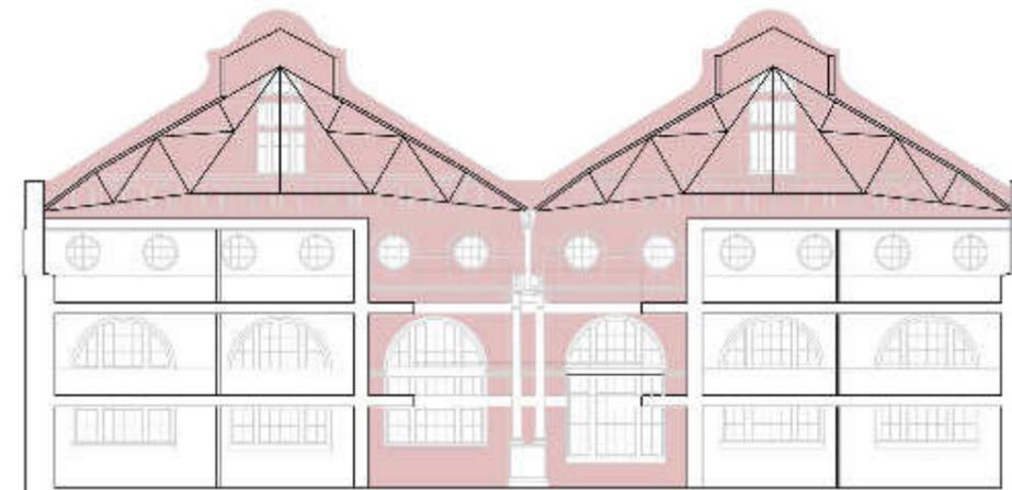
Abb. 302: Schnitt durch den Maschinenraum
