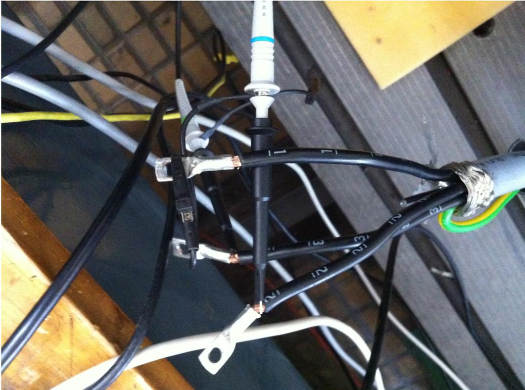
Abbildung 3.4.: An die Phasen angebrachte Tastköpfe zur Messung der induzierten Spannung
