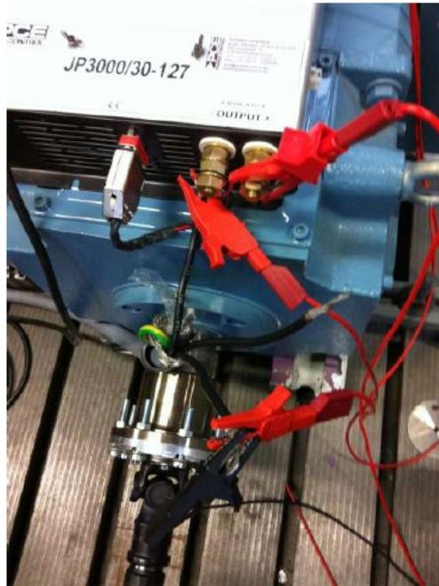
Abbildung 4.17.: Strangwiderstandsmessung mit Vierleitermethode
