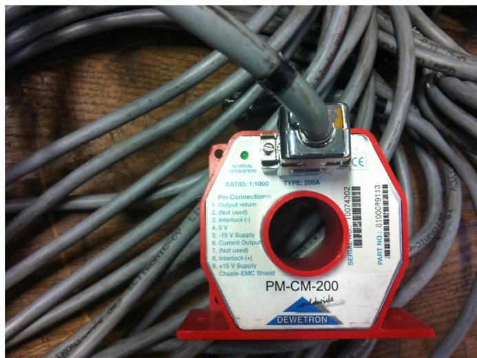
Abbildung 3.13.: Sensor PM-CM-200 zur Strommessung
