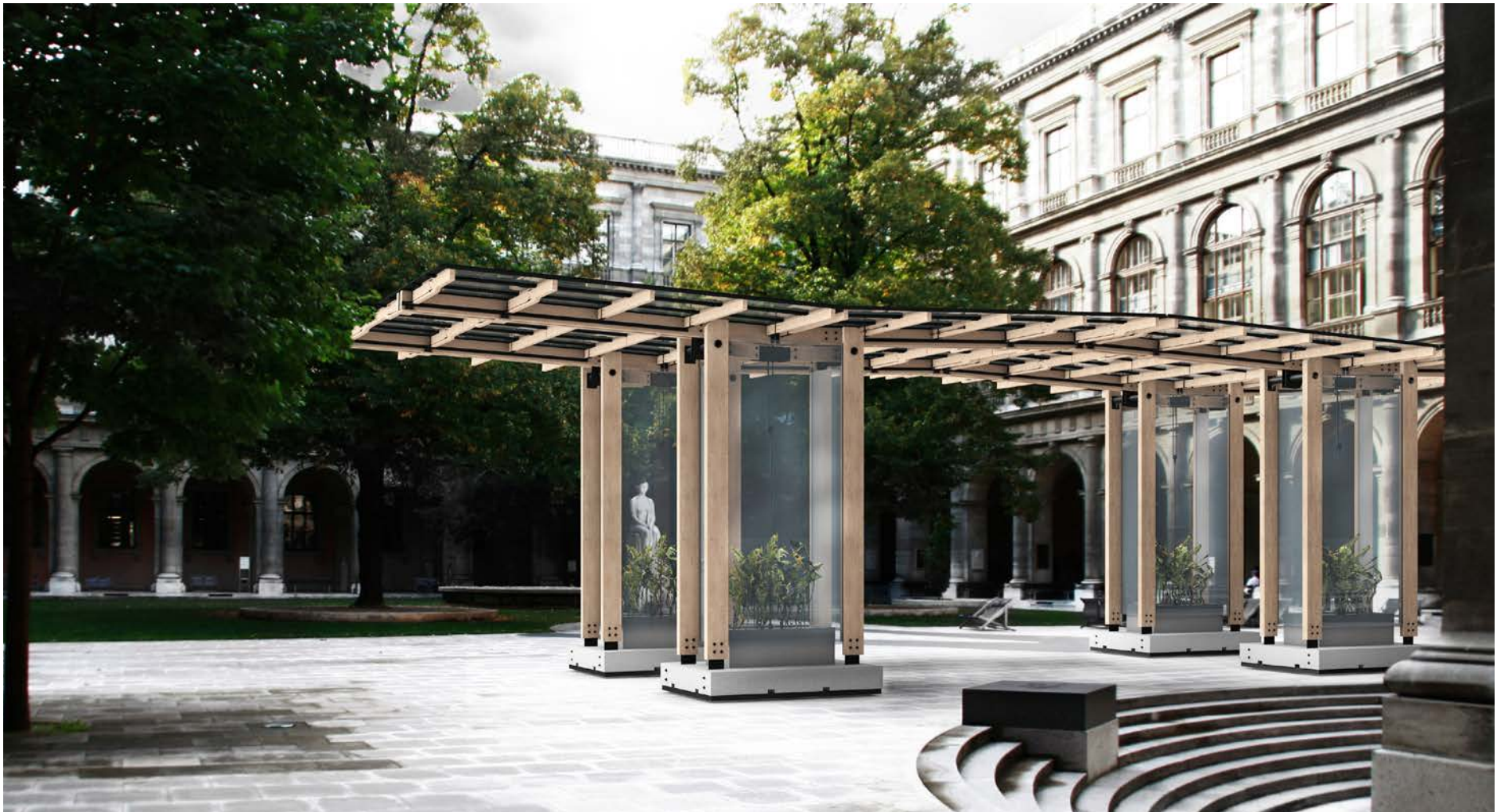
Abb.146.Illustration: Arkadenhof mit 4 Modulen, Konstruktion ist ganz geöffnet
