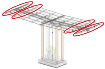
Abb.117. Queransicht: Sekundärträger 5 am Anschlusspunkt zweier Module
