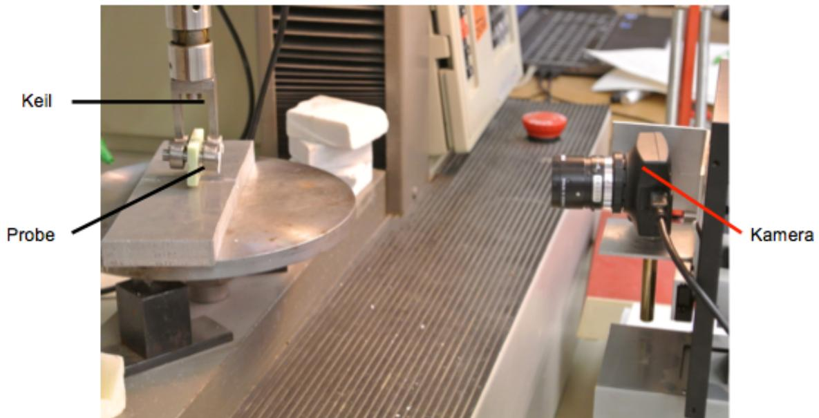
Abb. 15: Versuchsanordnung für die Videoextensimetrie
