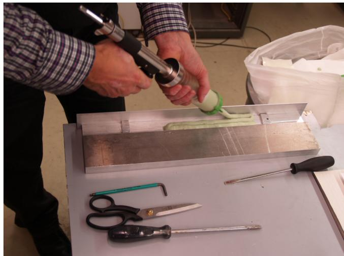
Abb. 3: Vorbereiten der Knochenzementproben
