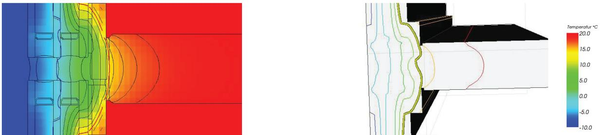
Abb. 136 WinIso / Antherm - HGV-Konstruktion mit Edelstahlabstandhalter, 24mm Überdeckung BKF
