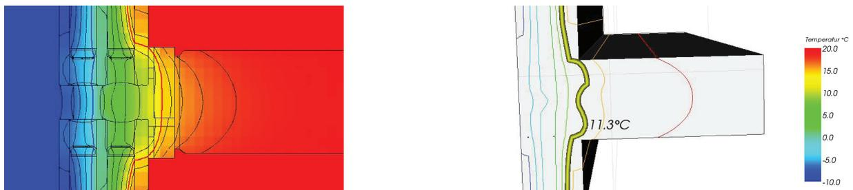
Abb. 145 Thermischer Output - HGV mit winkelförmiger Koppelleiste (Winiso - Antherm)
