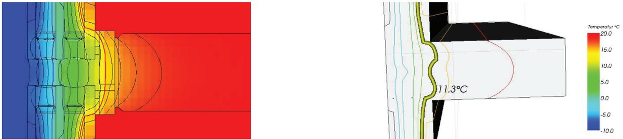
Abb. 135 WinIso / Antherm - HGV-Konstruktion mit Warm Edge Hybrid
