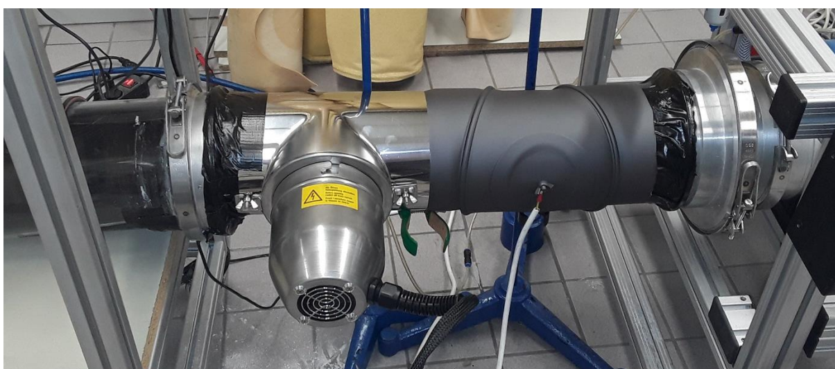
Abbildung 31: Eingebauter Elektroabscheider am Prüfstand
