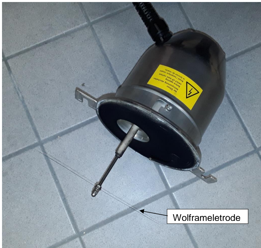
Abbildung 32: Elektroabscheider mit Wolframelektrode
