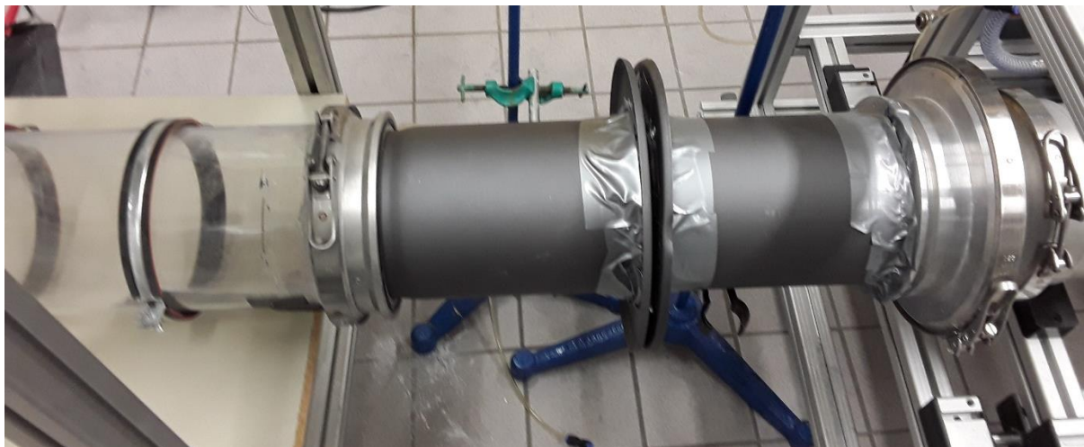
Abbildung 30: Filtermittelhalter zur Aufnahme einer 150 mm im Durchmesser bestehenden Filtermittelrunde
