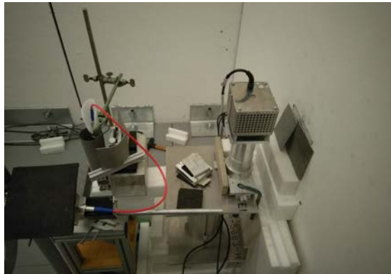
Abbildung 7.2: Experimentieraufbau der Flugzeitmessung bei einer Distanz zwischen Chopper und Detektor von 40 cm. Der Detektor (links im Bild) wird mit einer Blende und zusätzlichen Cadmiumplättchen abgeschirmt, er ist mit einem Vorverstärker verbunden, der mit Borgummi abgedeckt wurde.
