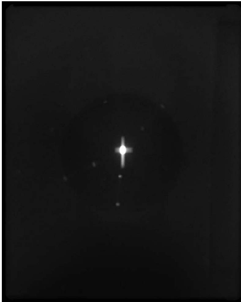
Abbildung 5.2: Aufnahme der punktförmigen Braggreflexe.
