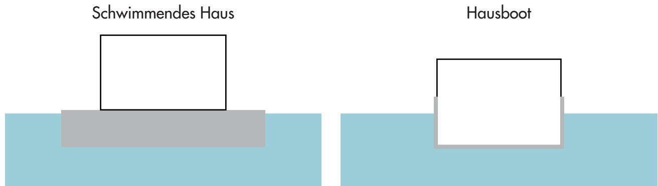
Abbildung 1: Unterschied Hausboot / Schwimmendes Haus (eigene Darstellung)
