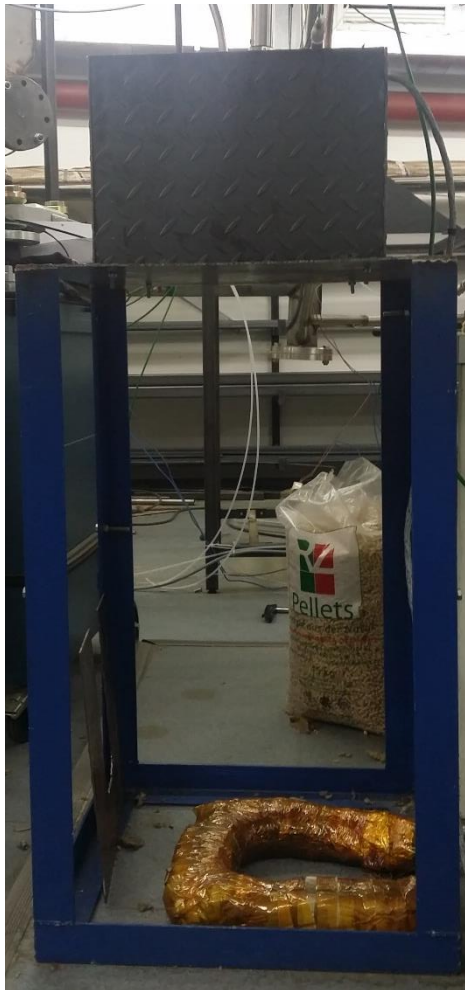
Abbildung 12, Reaktorbereich (Stahlgestell) mit Isoliergehäuse
