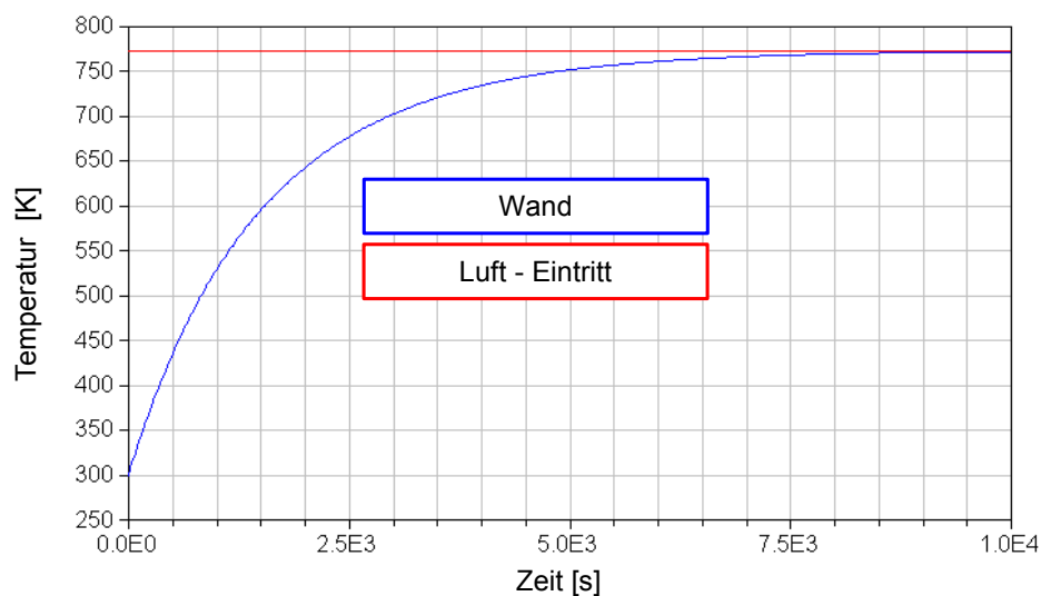
Abbildung 6.20: Die Aufwärmung der Stahlwand
