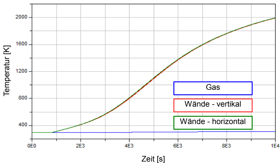
Abbildung 7.23: Die Temperaturänderung der Wände in der Zelle, in der keine Verbrennung stattfindet
