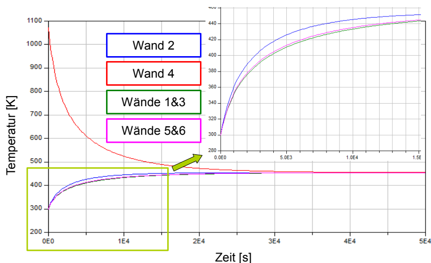
Abbildung 6.26: Temperatur der Wände während der ersten Simulation
