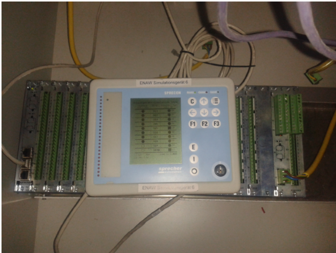
Abbildung 5.2: Testaufbau bestehend aus Simulationsgerät mit angeschlossener monochromer Bedieneinheit.
