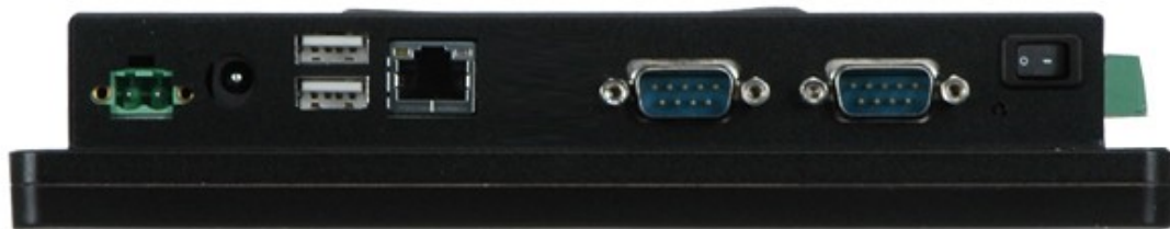
Abbildung 4.9: Schnittstellen an der Unterseite des IOVU-07F-AD Panel-PCs [11].
