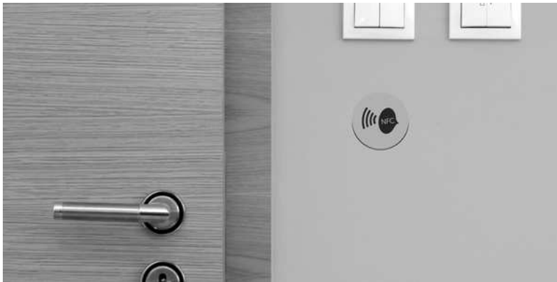
Abbildung 3.1: Beispielhafte Montage eines Raum-Tags Quelle: www.allviewmobile.de
