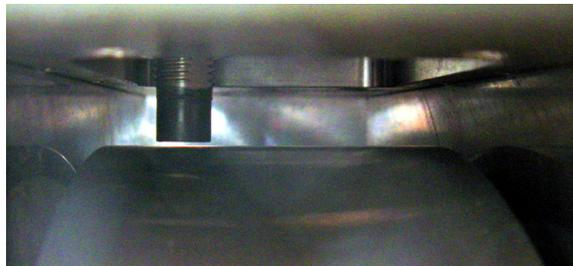
(b) Messspalt Wirbelstromsensor
