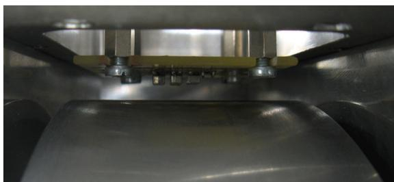
(a) Messspalt optischer Sensor
