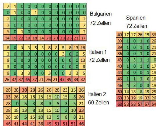
Abbildung 1.11: Verteilung der degradierten Zellen im Solarmodul (die Zahlen geben den prozentuellen Abfall der Nennleistung der einzelnen Zellen an) [19]
