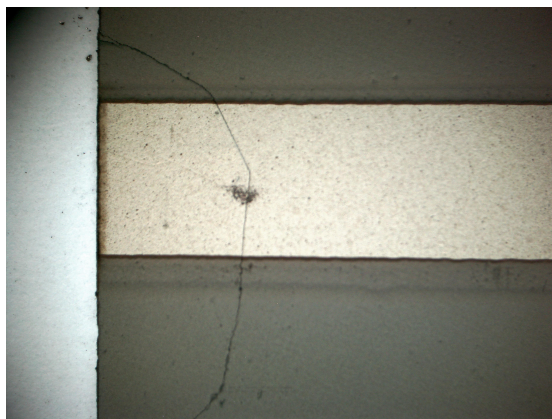
Abbildung 2.16: Bruch von Rückseite betrachtet
