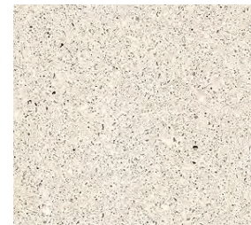
Zwischenwände mit Kalksteinbeton gesäuerte Oberfläche
