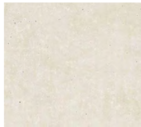
Strukturelle Betonteile im Inneren aus Kalksteinbeton schalungsroh
