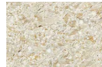
Muster Kalksandsteinbeton, Gestockte Oberfläche
