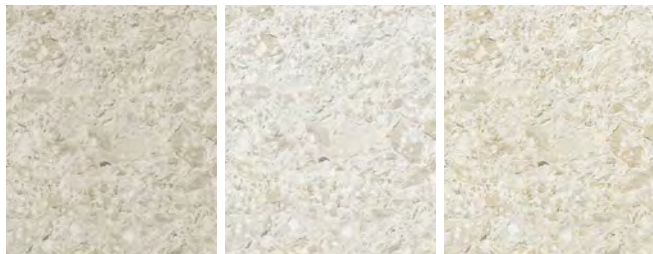
Vorgefertige Beton-Fassadenelemente Kalksteinbeton gestockt, mit unterschiedlichem Farbton durch variierender Mischung
