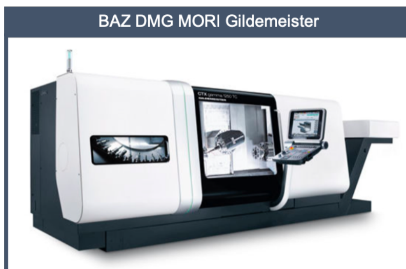
Abbildung 9.1: Bearbeitungszentrum DMG MORI Gildemeister CTX GAMMA 1250 TC [31]
