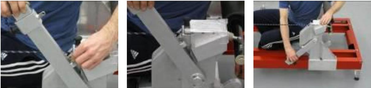
Abbildung 58: Herunterklappen der Hantelstangenbefestigung am Rumpfbeugemechanismus
