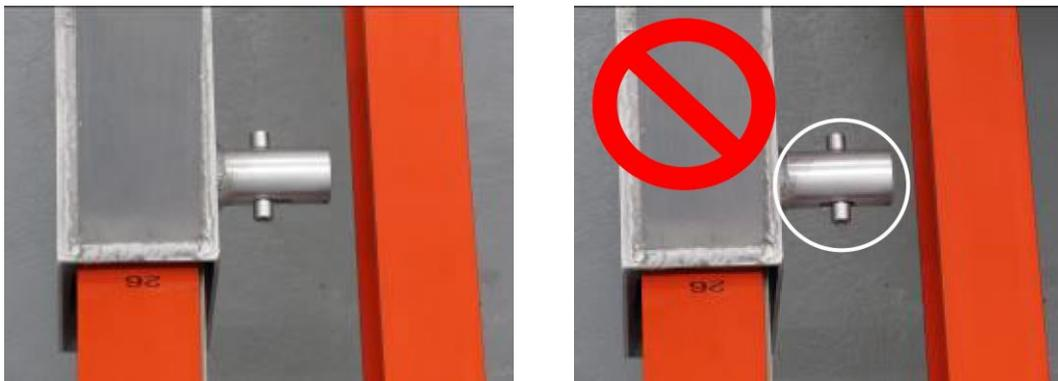
Abbildung 93: Richtiges Einrasten der Sicherheitsböcke
