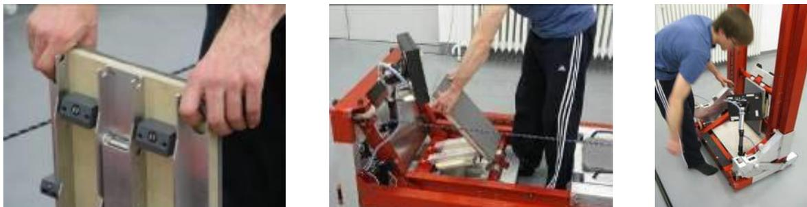
Abbildung 282: Einklappen der Lehne und Verstauen des Monitors
