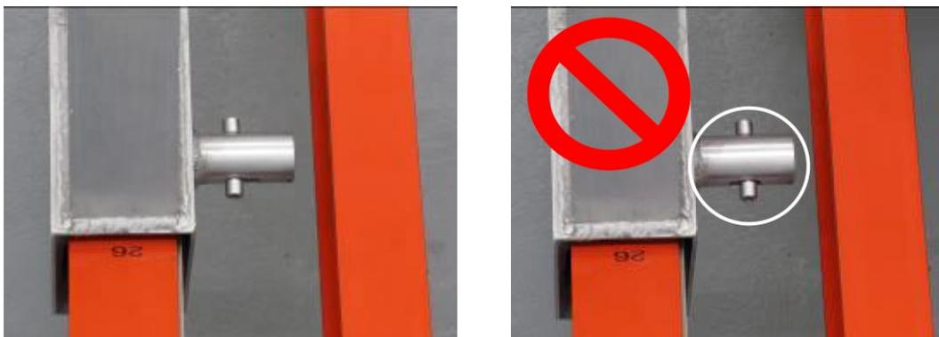
Abbildung 100: Richtiges Einrasten der Sicherheitsböcke
