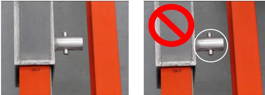
Abbildung 169: Richtiges Einrasten der Sicherheitsböcke
