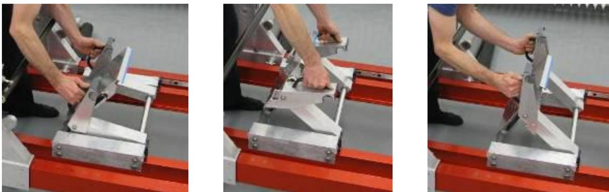
*Abbildung 121: Umbau des Ruderschlittens für die Übung Beinpresse*
