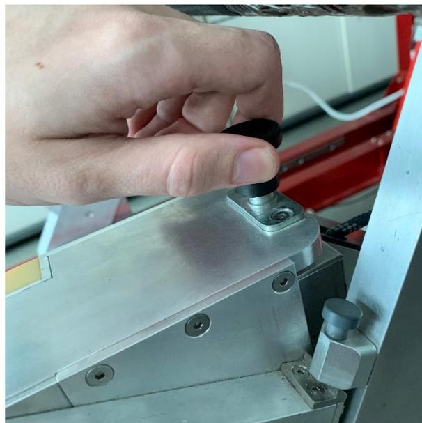
Abbildung 136: Entriegeln des Rumpfbeugemechanismus
