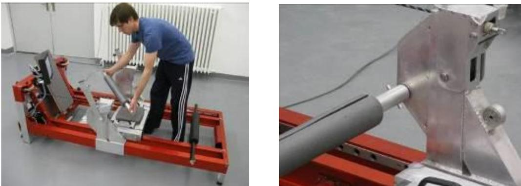
Abbildung 229: Einbau der Hüftquerstange für das Bauchtraining
