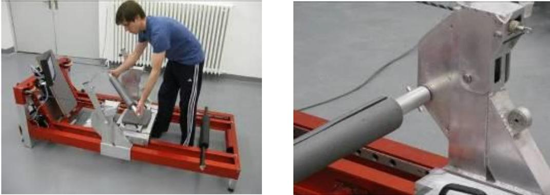
Abbildung 145: Einbau der Hüftquerstange für das Bauchtraining
