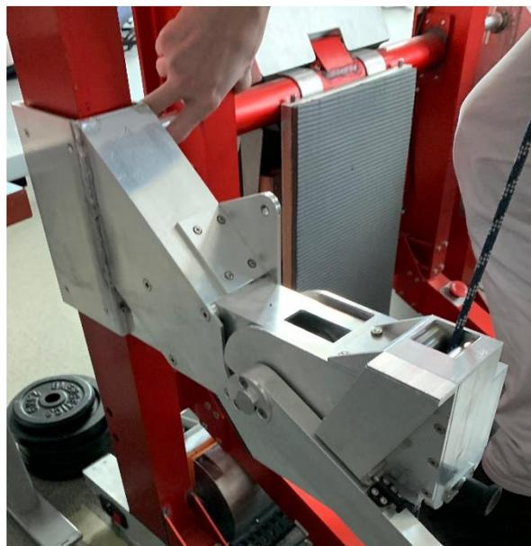
Abbildung 252: Positionierung der Sicherheitsböcke
