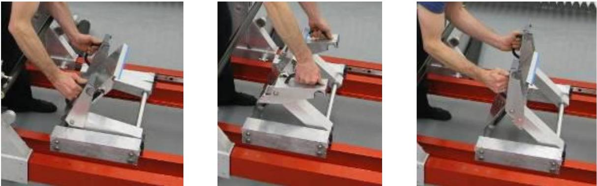
Abbildung 30: Umbau des Ruderschlittens für die Übung Beinpresse
