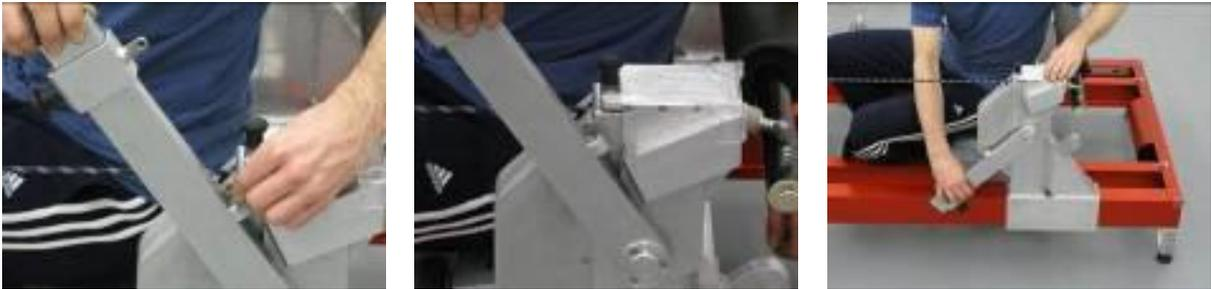
Abbildung 233: Herunterklappen der Hantelstangenbefestigung am Rumpfbeugemechanismus
