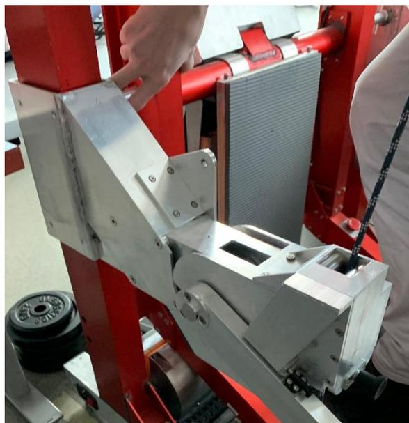
Abbildung 68: Positionierung der Sicherheitsböcke
