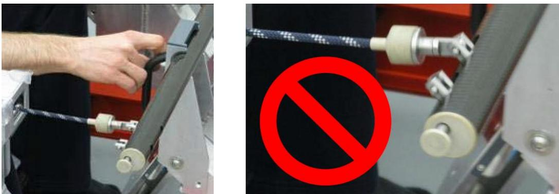
Abbildung 127: Richtige Ausrichtung der Hantelstange im Ruderschlitten
