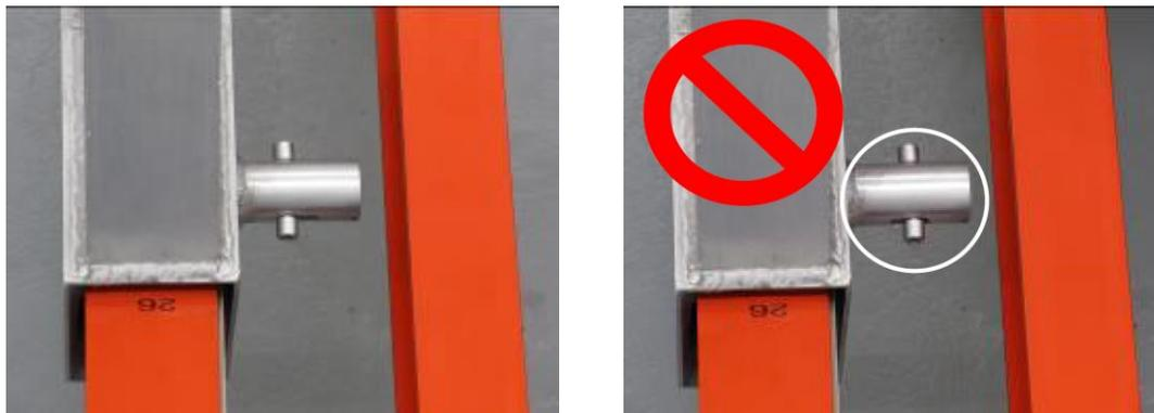
Abbildung 268: Richtiges Einrasten der Sicherheitsböcke
