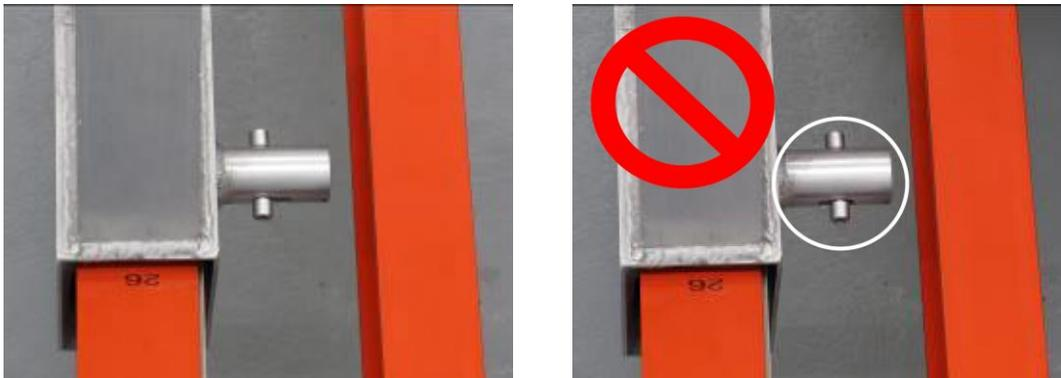
Abbildung 41: Richtiges Einrasten der Sicherheitsböcke
