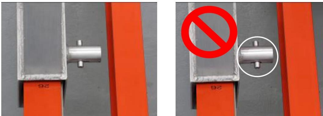
Abbildung 32: Richtiges Einrasten der Sicherheitsböcke
