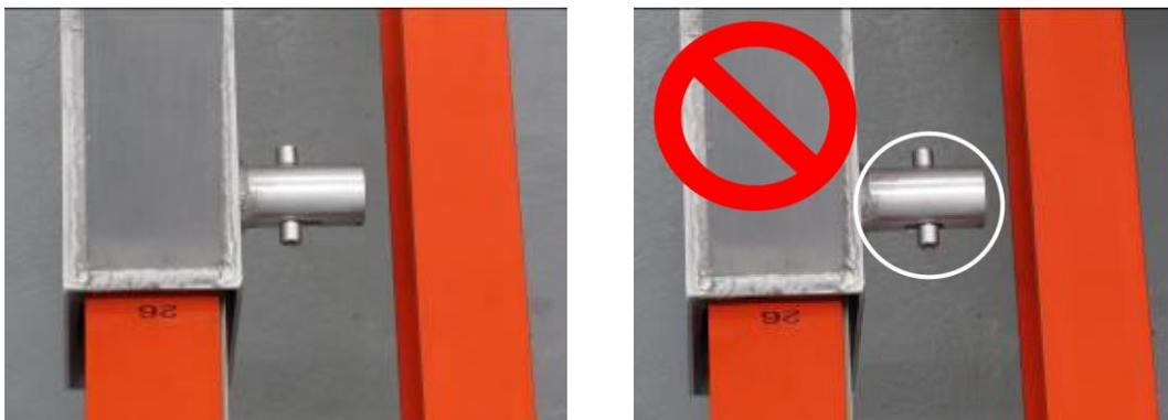
Abbildung 114: Richtiges Einrasten der Sicherheitsböcke
