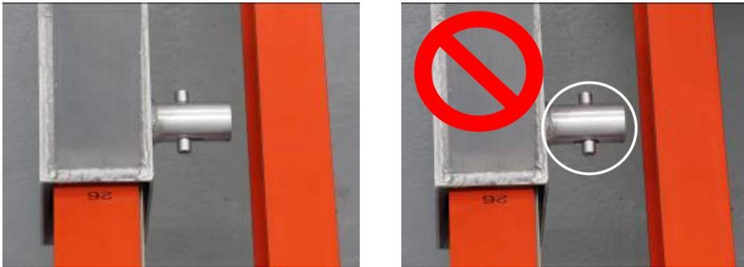
Abbildung 236: Richtiges Einrasten der Sicherheitsböcke
