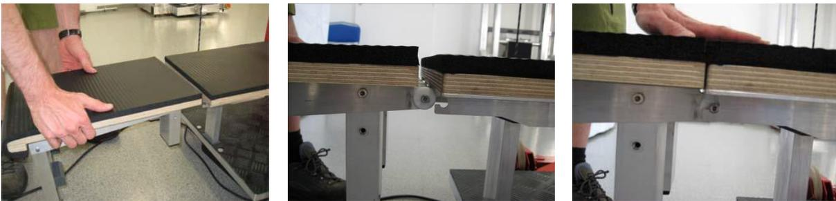
Abbildung 76: Montage der Bankerweiterung für die Übung Bankdrücken
