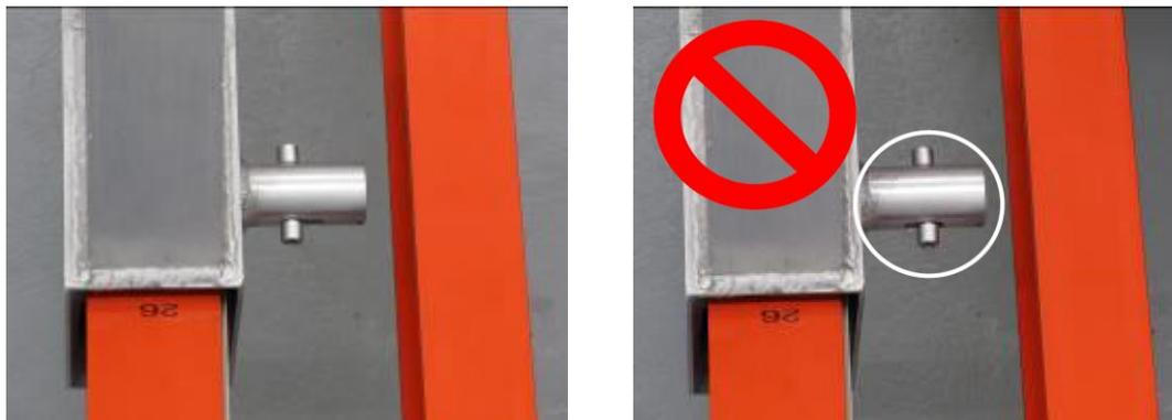
Abbildung 142: Richtiges Einrasten der Sicherheitsböcke
