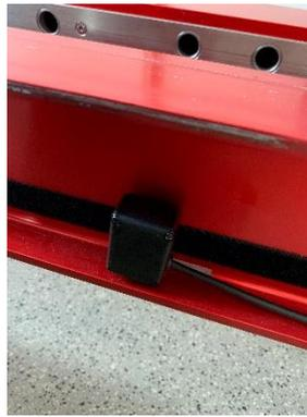
Abbildung 12: Montage Herzfrequenzempfänger
