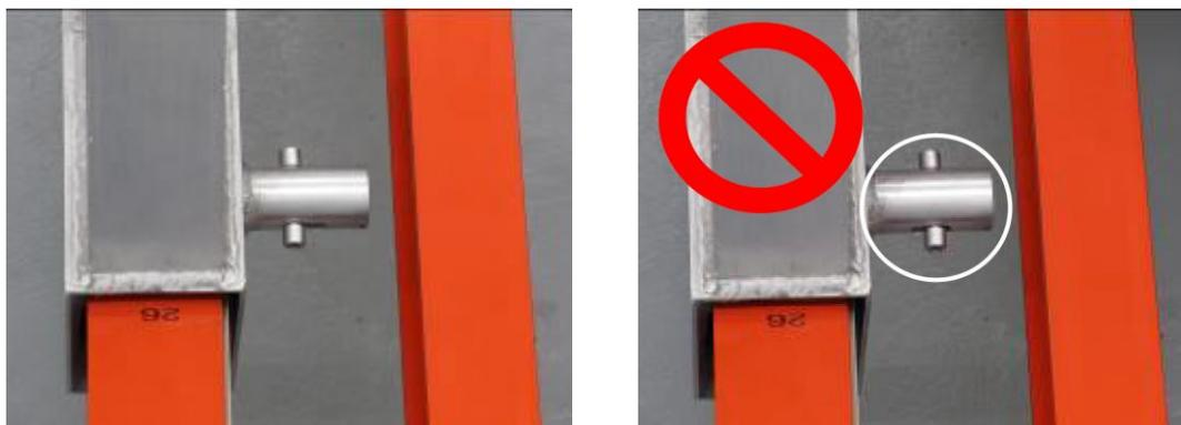
Abbildung 216: Richtiges Einrasten der Sicherheitsböcke
