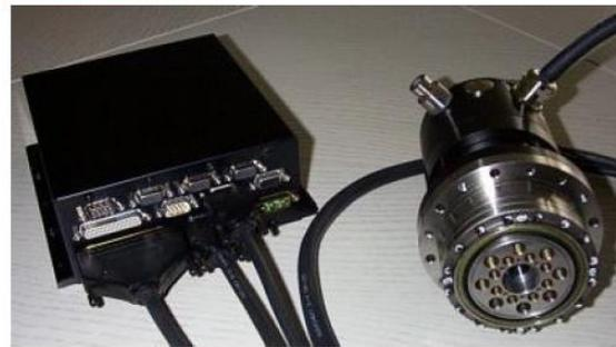
*SWM/048-25-R-ET mit einem RBE/HD-rotatorischem Aktuator*
