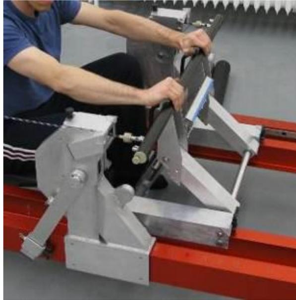
Abbildung 210: Montage der Hantelstange im Ruderschlitten
