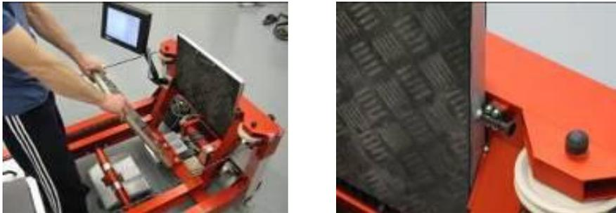
Abbildung 280: Lösen der Verriegelung der Trainingsplattform
