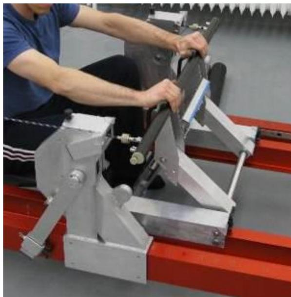
Abbildung 35: Montage der Hantelstange im Ruderschlitten
