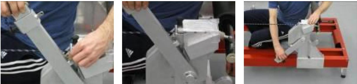
Abbildung 139: Herunterklappen der Hantelstangenbefestigung am Rumpfbeugemechanismus
