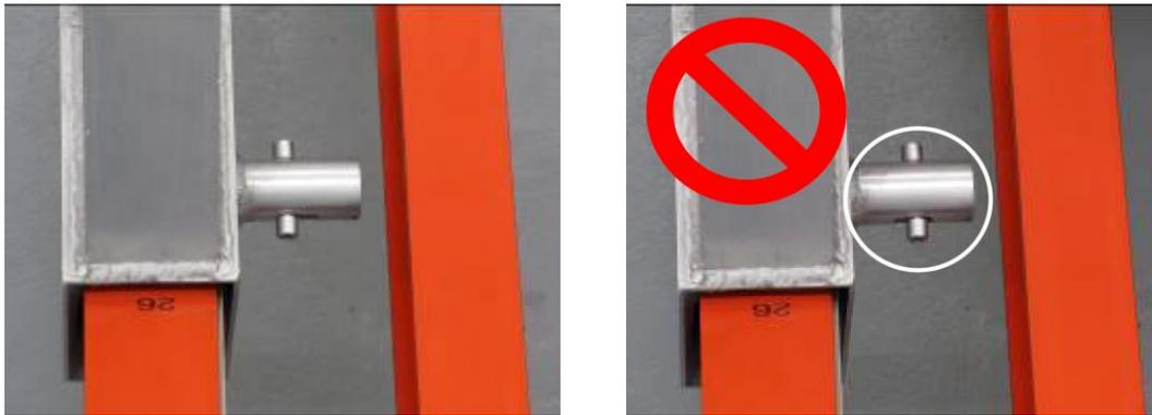
Abbildung 207: Richtiges Einrasten der Sicherheitsböcke
