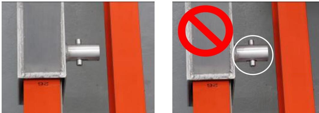
Abbildung 244: Richtiges Einrasten der Sicherheitsböcke
