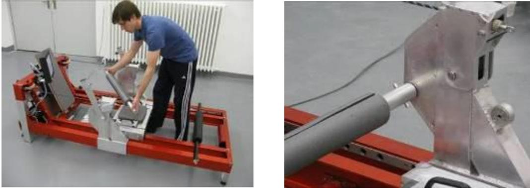
Abbildung 54: Einbau der Hüftquerstange für das Bauchtraining
