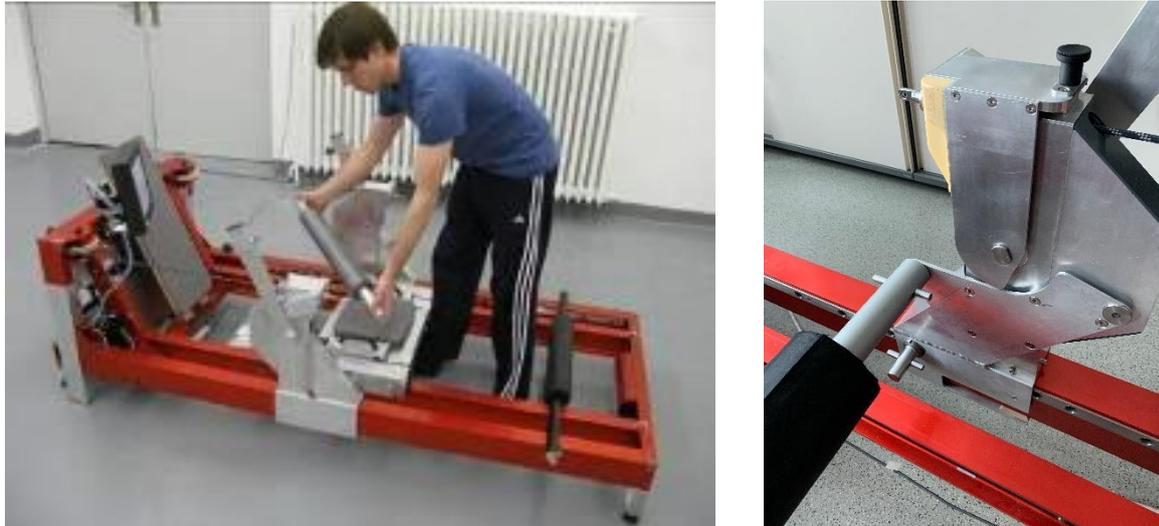
Abbildung 135: Einbau der Hüftquerstange für das Rückentraining
