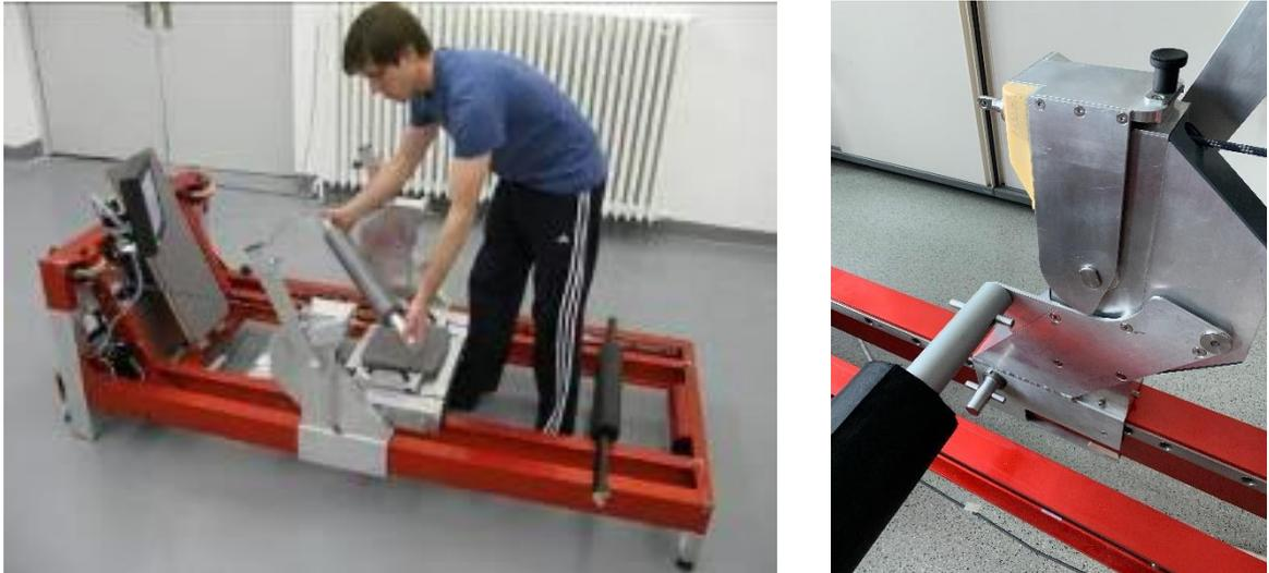
Abbildung 44: Einbau der Hüftquerstange für das Rückentraining
