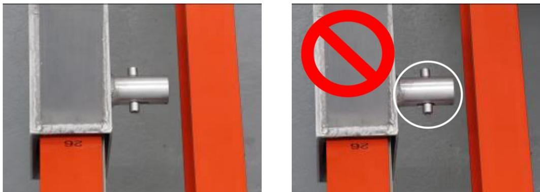
Abbildung 16: Richtiges Einrasten der Sicherheitsböcke
