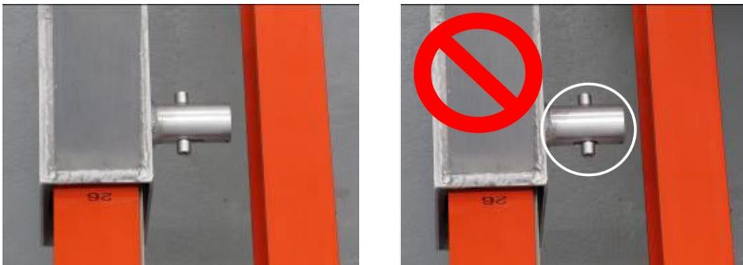
*Abbildung 86: Richtiges Einrasten der Sicherheitsböcke*
