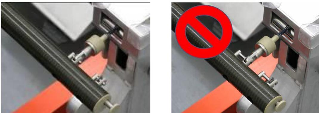
Abbildung 171: Richtiges Einrasten der Hantelstange
