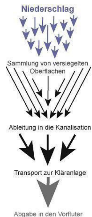
Abb. 5 Prinzip der Siedlungsentwässerung (eigene Darstellung)
