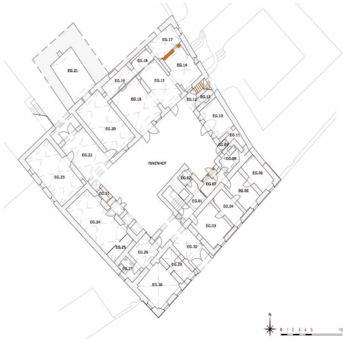
Abb.93: Bauphasenplan Erdgeschoß 8.Bauphase
