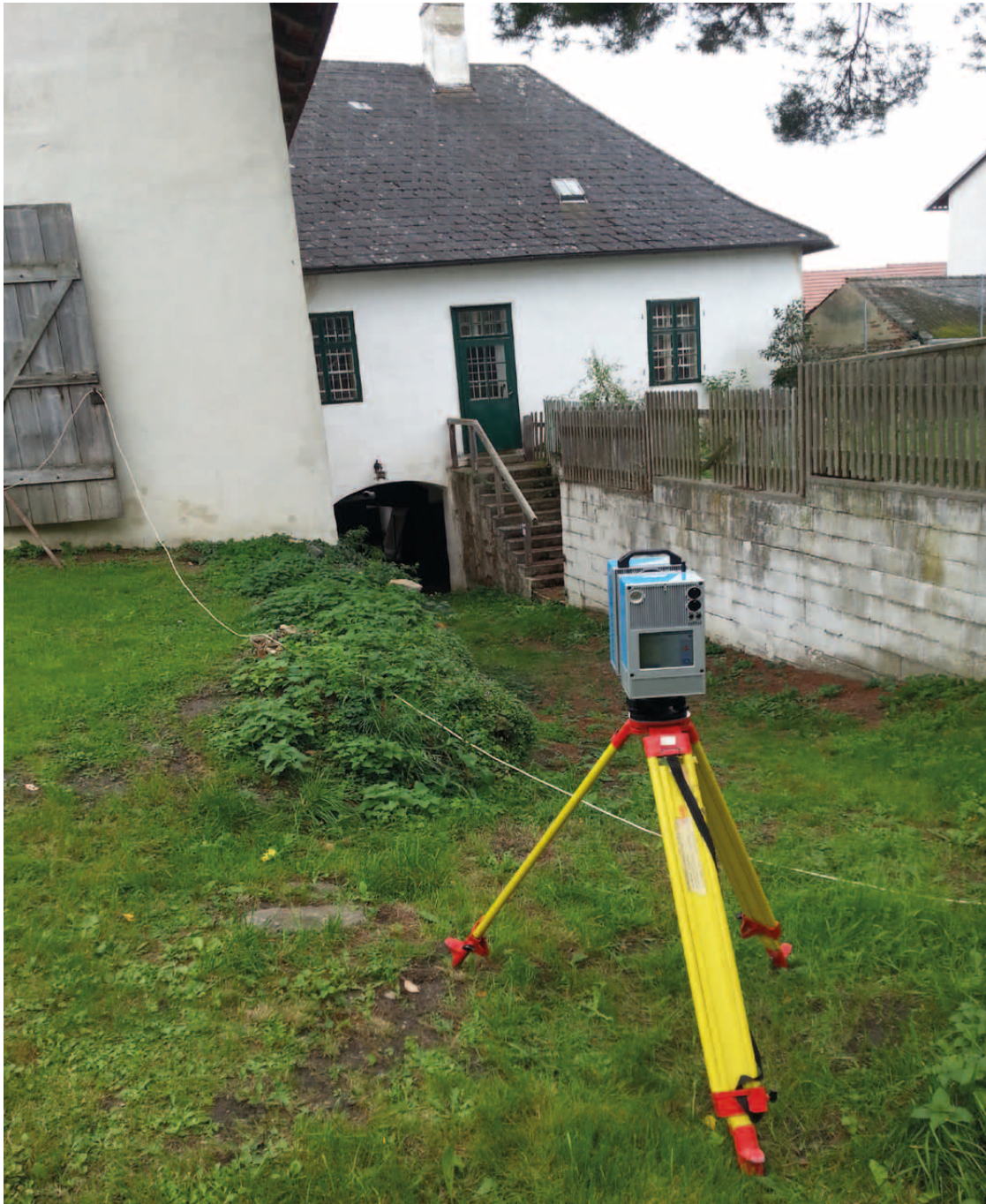
Abb.44: 3D Laserscanner von Zoller und Fröhlich an der Scanposition 271
