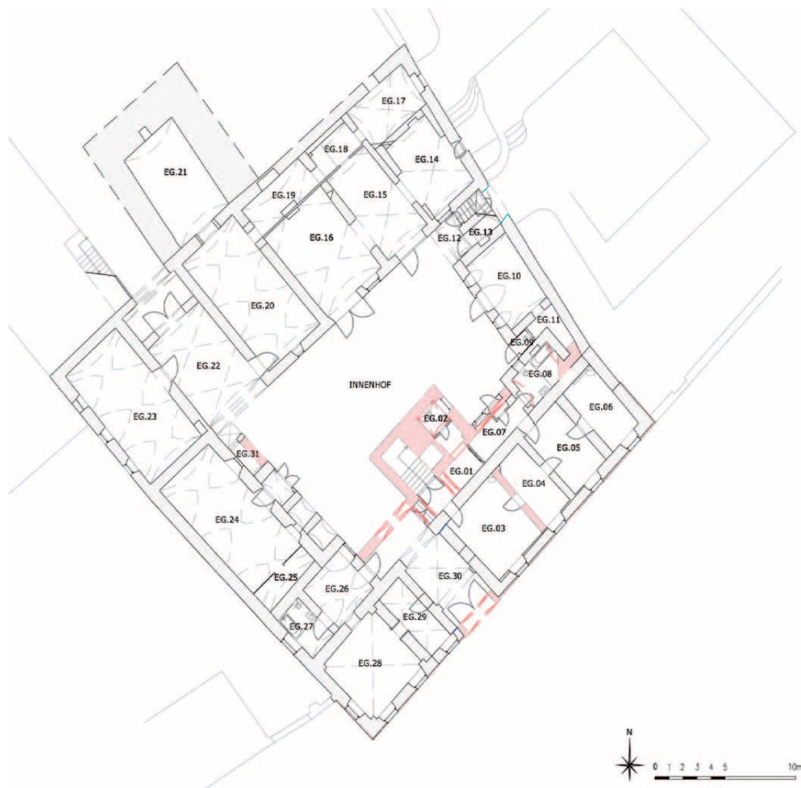
Abb.88: Bauphasenplan Erdgeschoß 7.Bauphase
