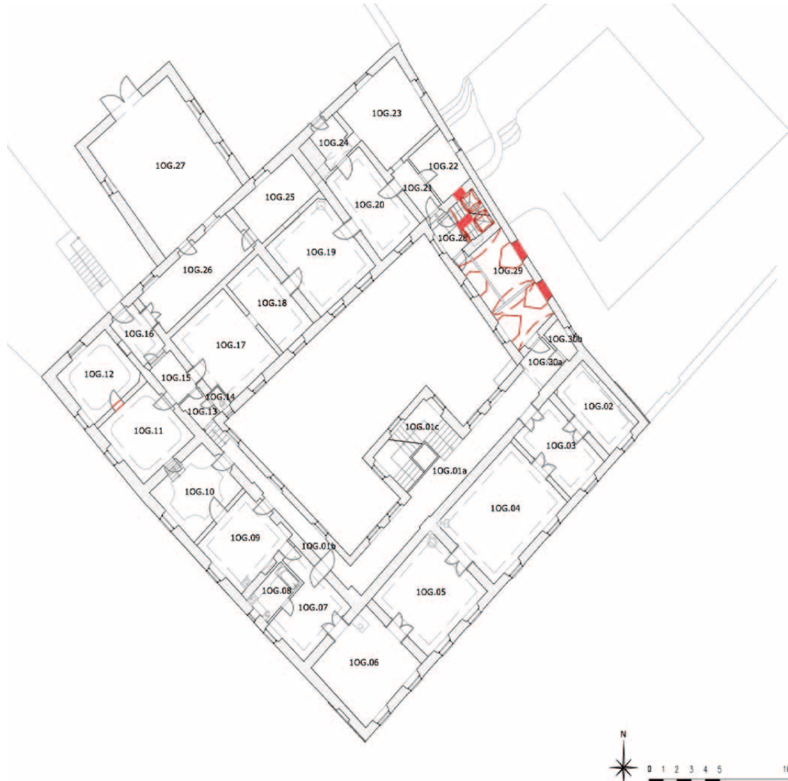
Abb.80: Bauphasenplan Obergeschoß 6.Bauphase
