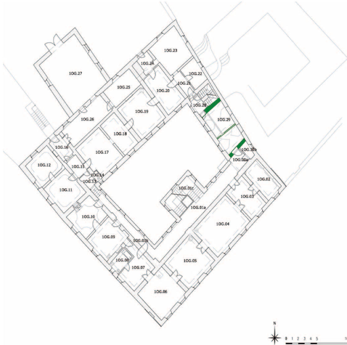
Abb.69: Bauphasenplan Obergeschoß 3.Bauphase
