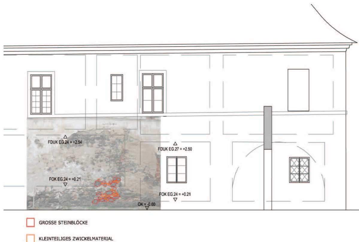
Abb.59: Westfassade mit Verortung des Detailfotos und eingezeichnetem Netzmauerwerk
