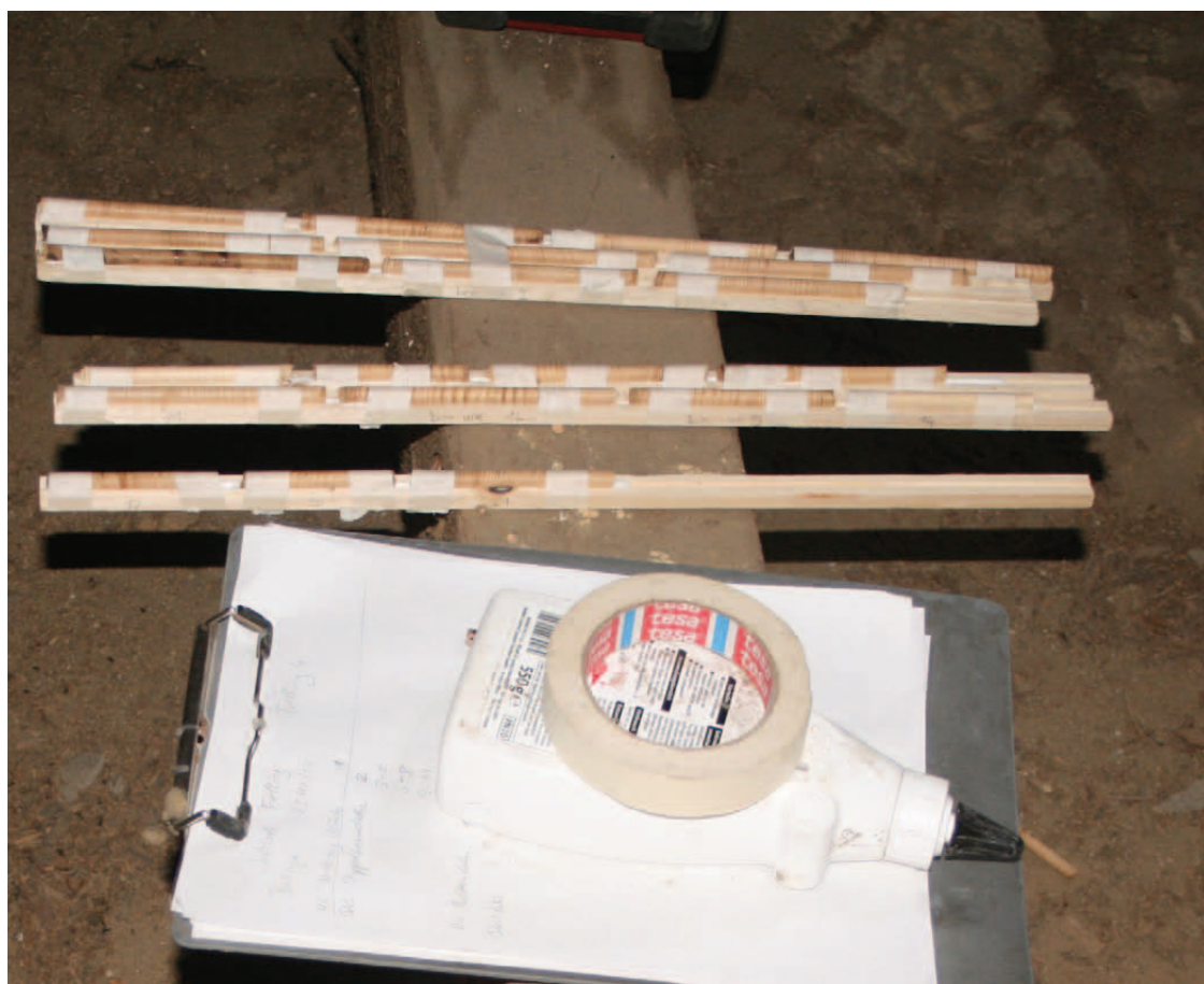
Abb.25: Dendroproben nach der Entnahme
