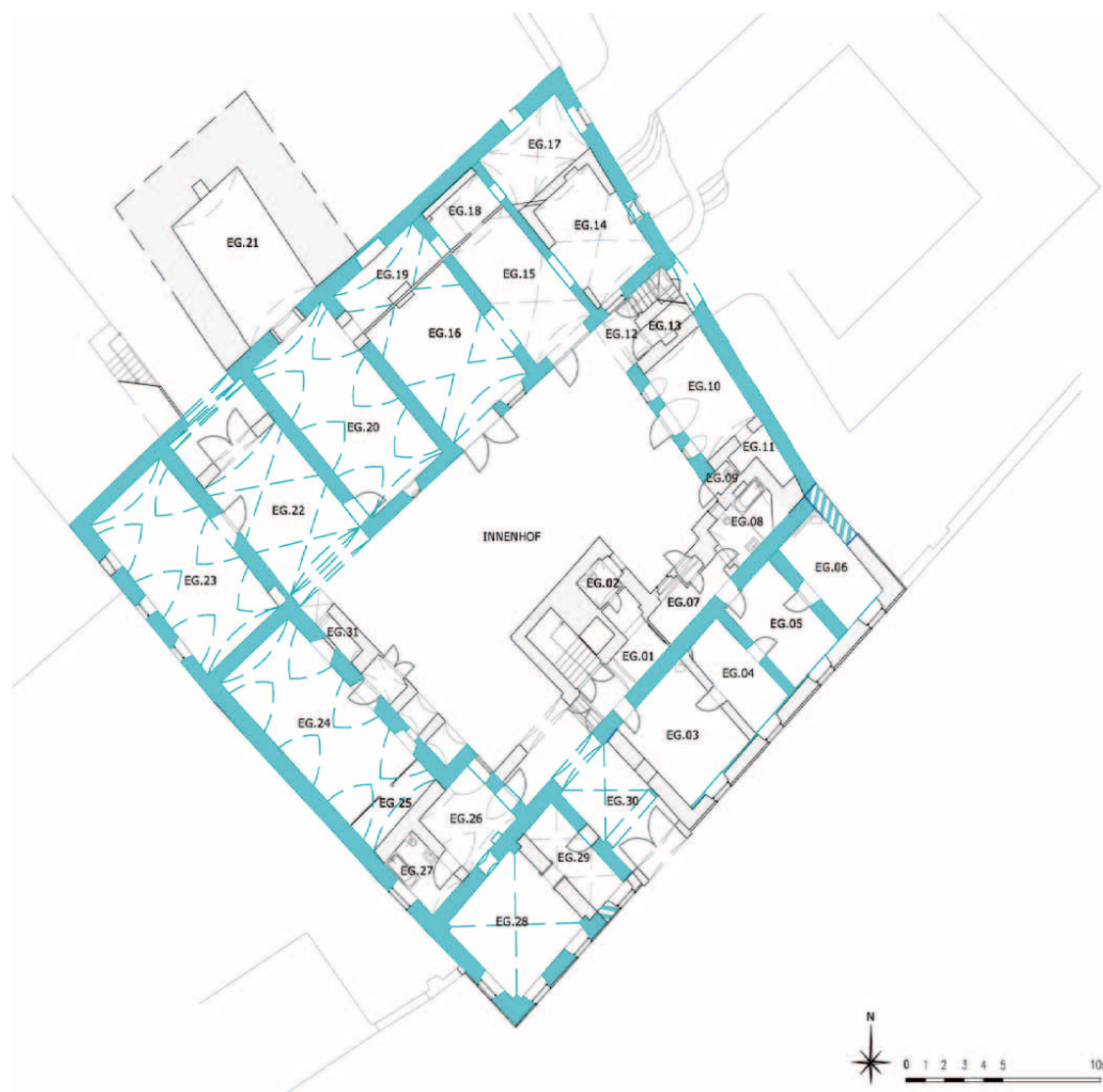
Abb.61: Bauphasenplan Erdgeschoß 2.Bauphase
