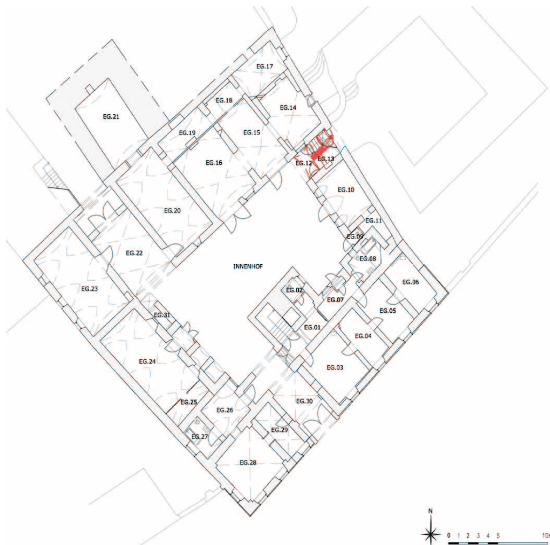
Abb.79: Bauphasenplan Erdgeschoß 6.Bauphase
