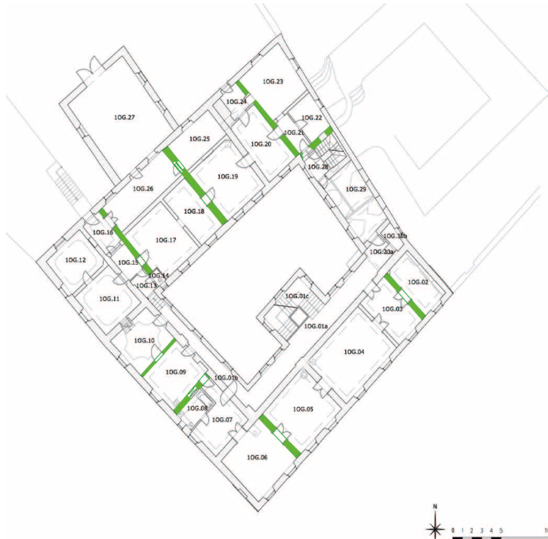
Abb.74: Bauphasenplan Obergeschoß 4.Bauphase
