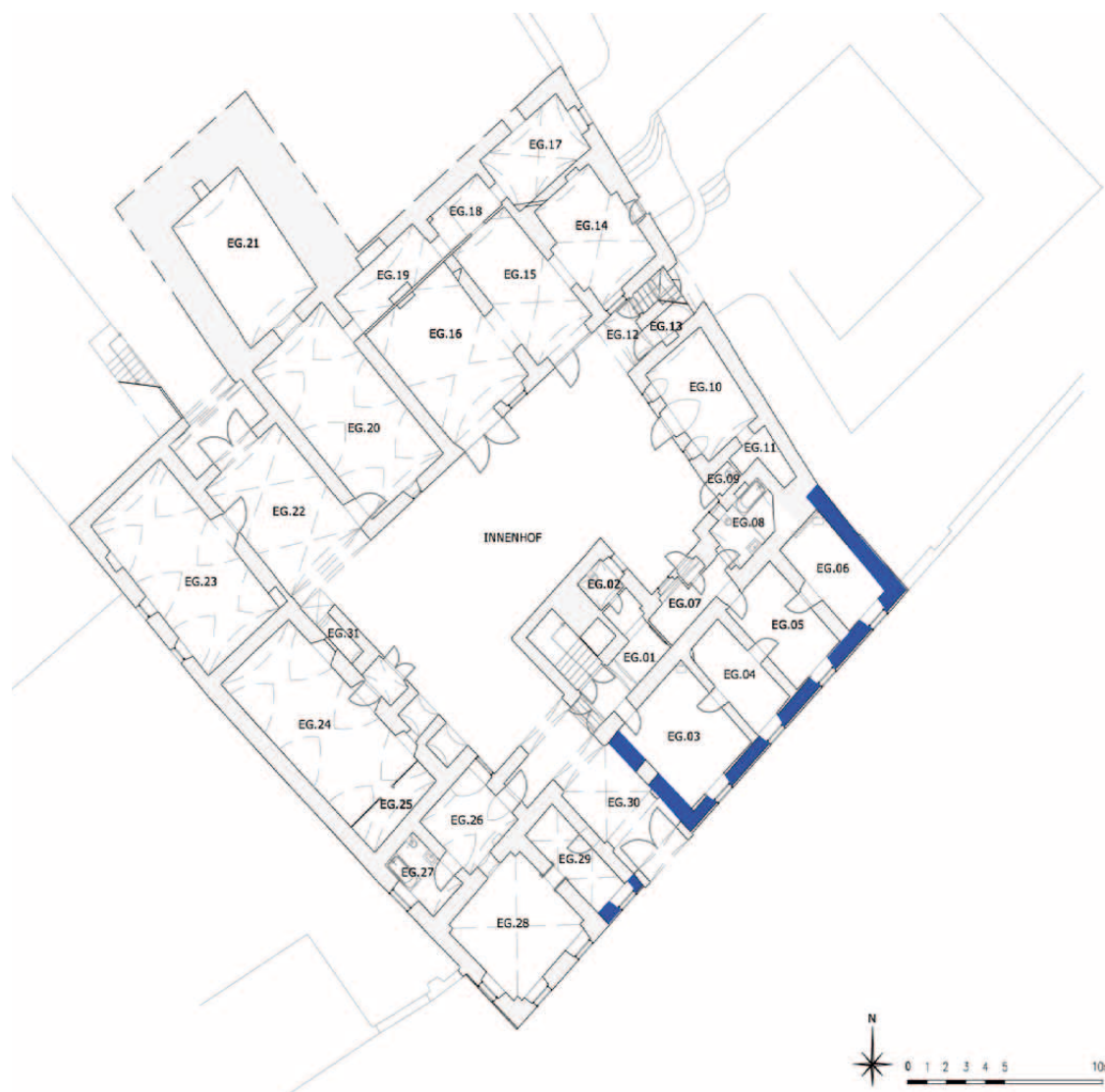
Abb.58: Bauphasenplan Erdgeschoß 1.Bauphase
