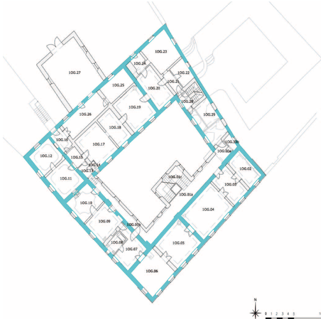
Abb.62: Bauphasenplan Obergeschoß 2.Bauphase
