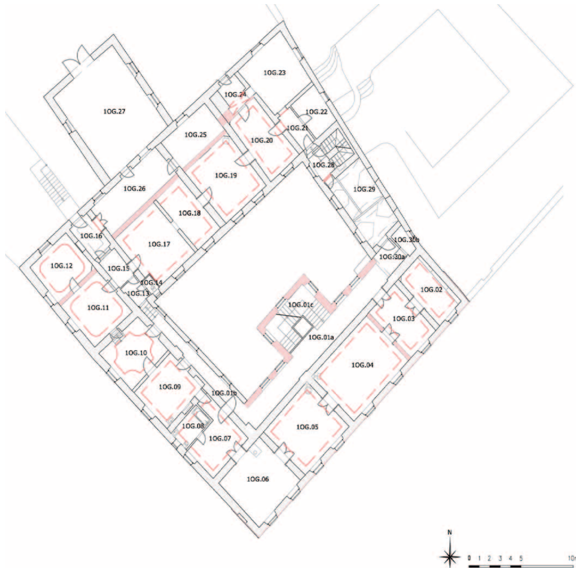
Abb.90: Bauphasenplan Obergeschoß 7.Bauphase
