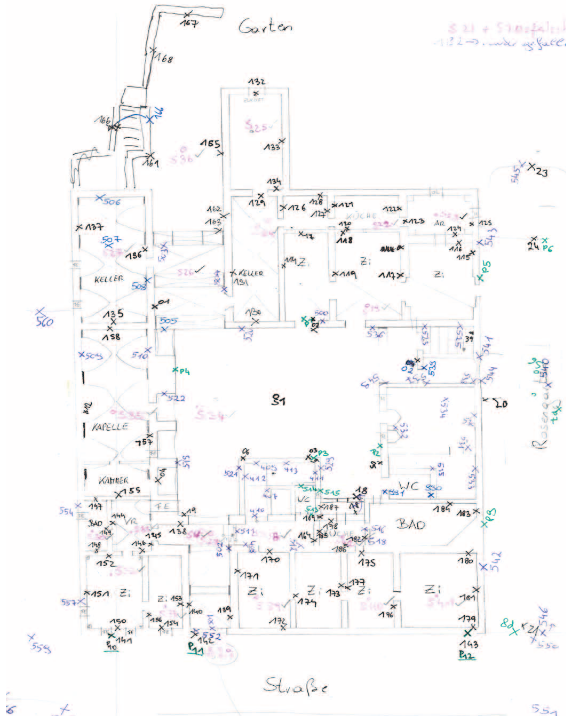
Abb.41: Handskizze EG nach erster Begehung mit markierten Passpunkten und Tachymeterstandpunkte
