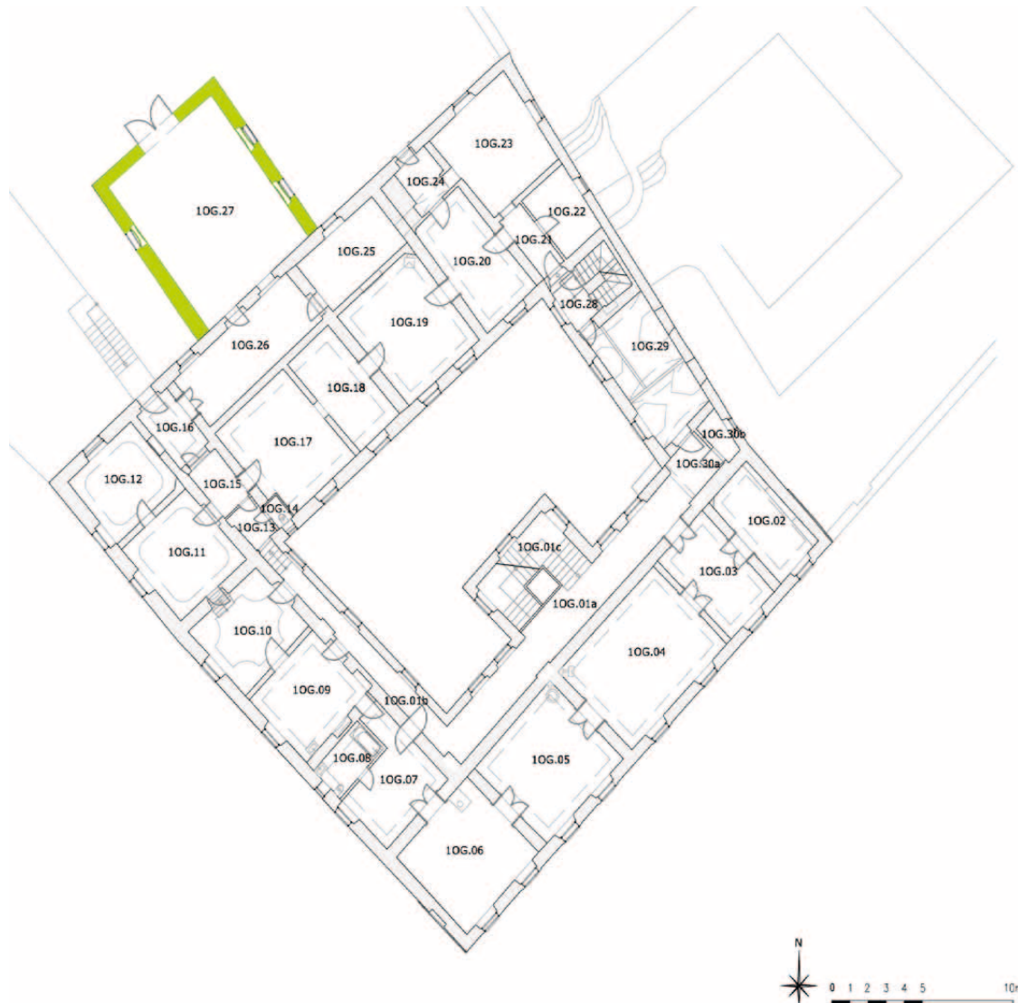
Abb.77: Bauphasenplan Obergeschoß 5.Bauphase
