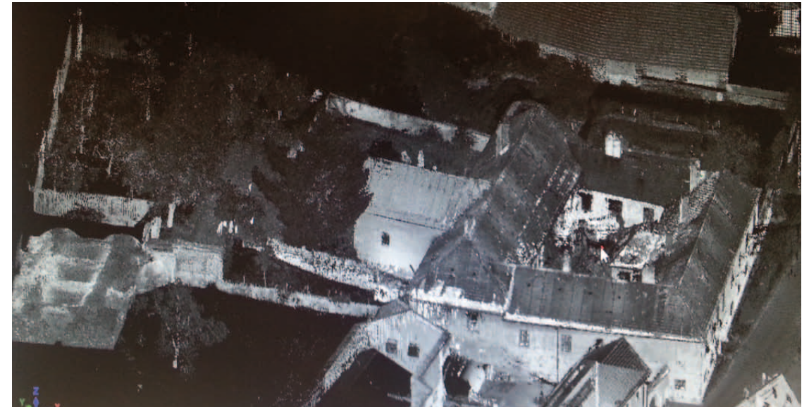
Abb.46: Nach Verknüpfung aller Scanpositionen kann im Zoller und Fröhlich Programm eine Gesamt 3D Ansicht erstellt werden. In dieser Gesamtansicht werden als letzten Schritt Schnittebenen definiert.
