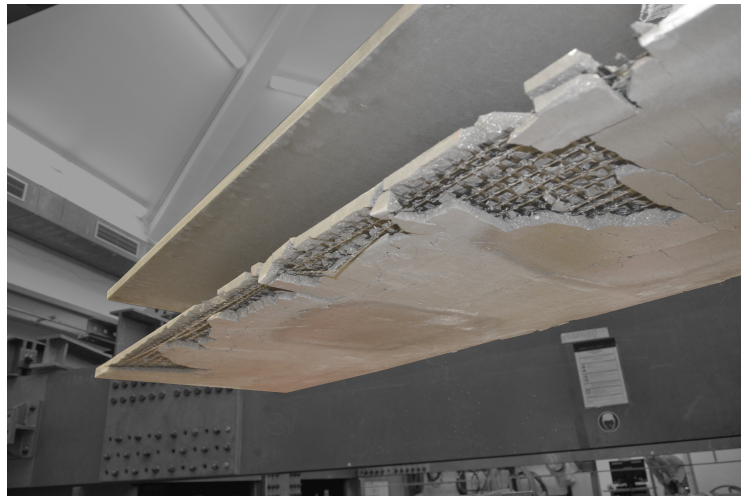
(b) Spaltrissbildung während eines Biegeversuches
