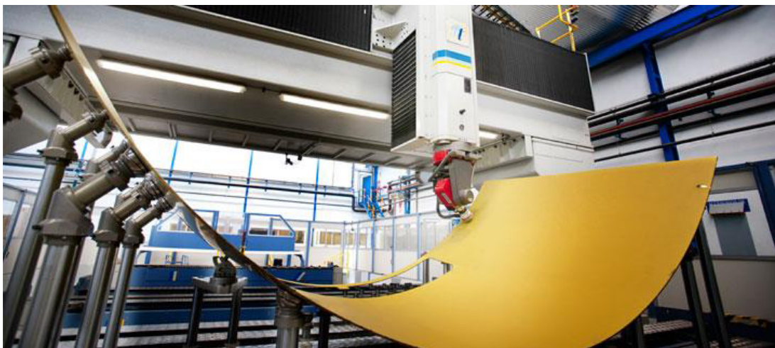
Abbildung 32: TORRESLASER bei der Bearbeitung eines Flugzeugbauteiles [15]
