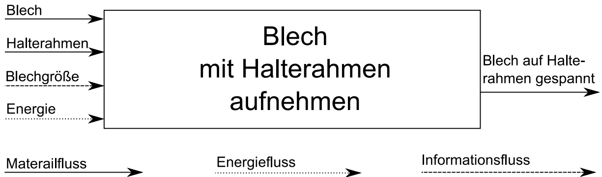
Abbildung 34: Gesamtfunktion des Halterahmens
