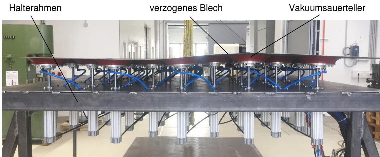
Abbildung 49: Halterahmen mit angesaugtem Blech
