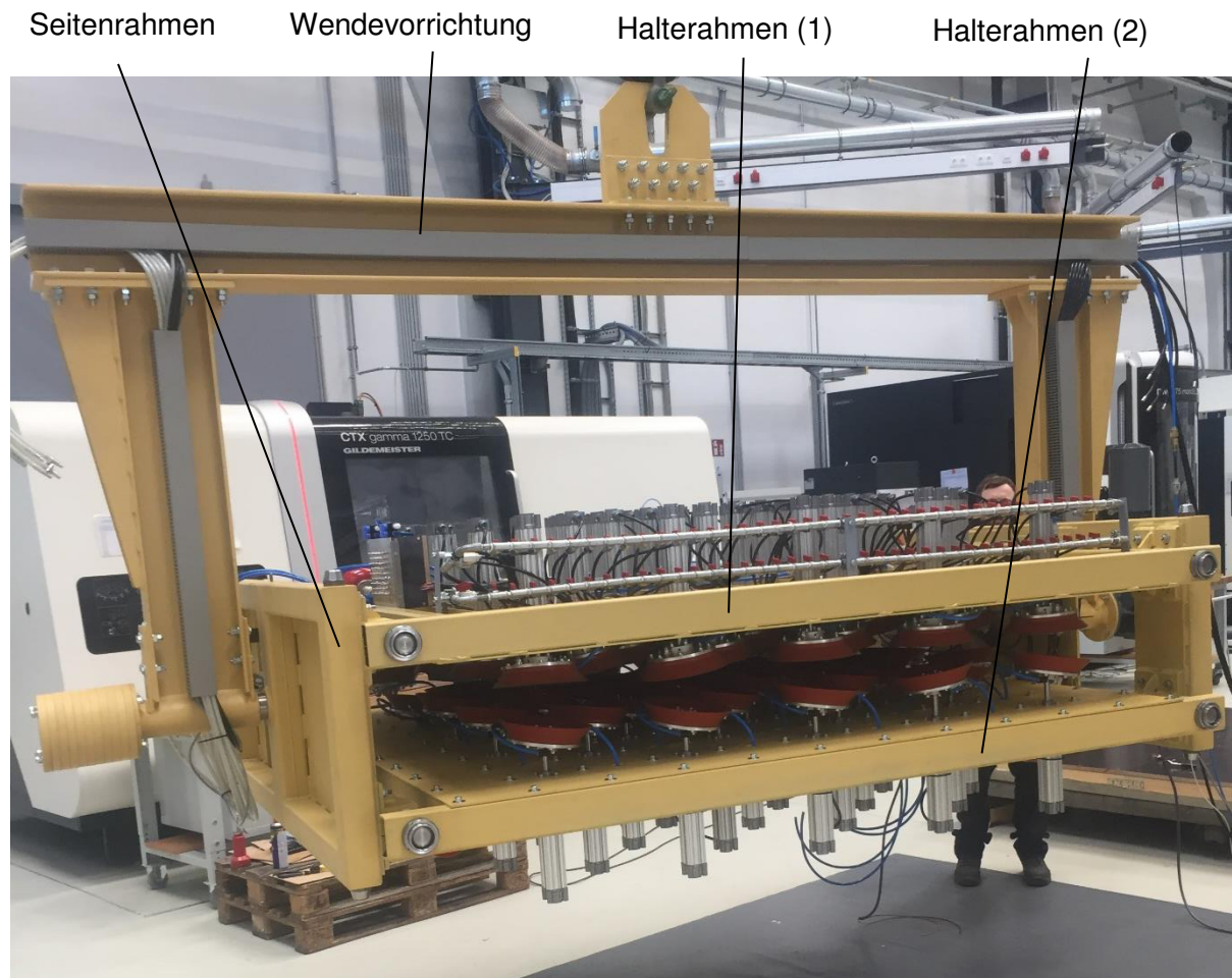
Abbildung 41: Halterahmen und Wendevorrichtung mit Hauptbaugruppen
