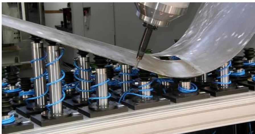
Abbildung 30: Spannung von labilen Blechbauteilen mittels UHF-System [13]
