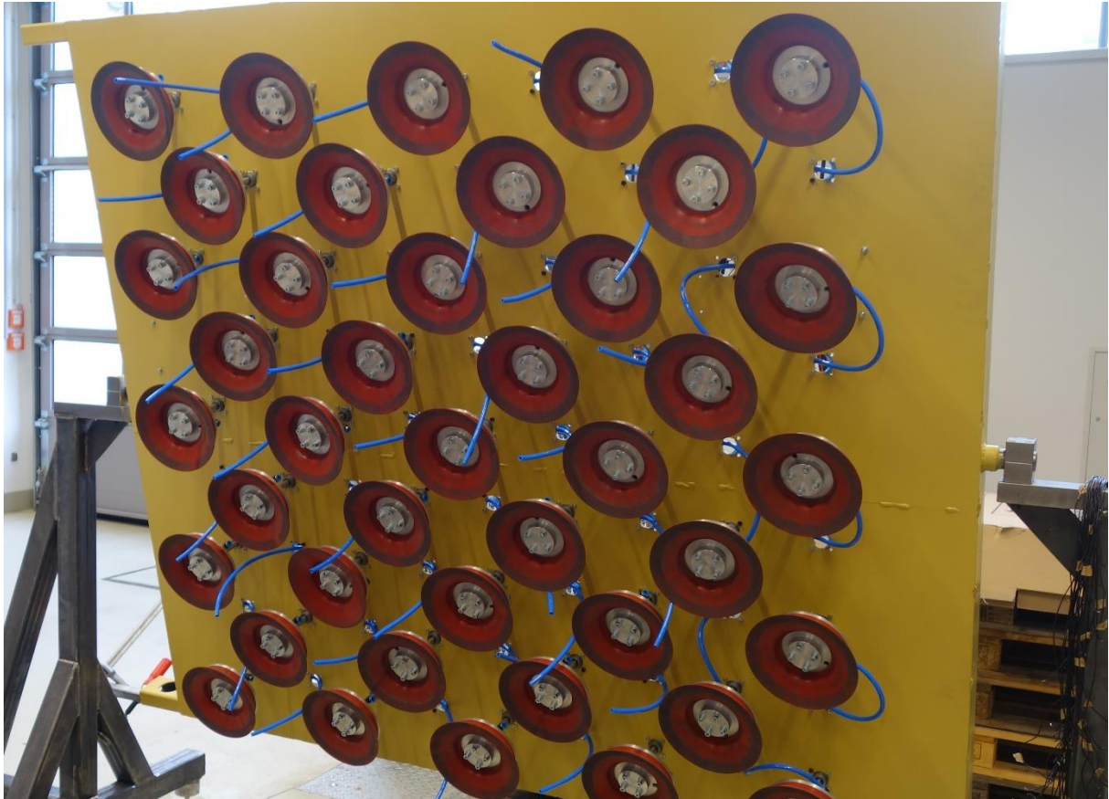
Abbildung 45: Befestigung der Vakuumsaugteller am Halterahmen
