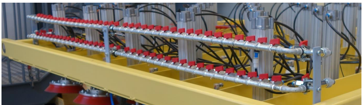
Abbildung 52: Realisierte Ausführung der Verschaltung der Zylinder
