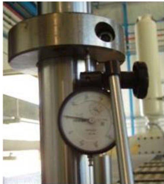
Abbildung 22: Ermittlung von Positionsabweichungen mit Messuhr TORRESTOOL [12]
