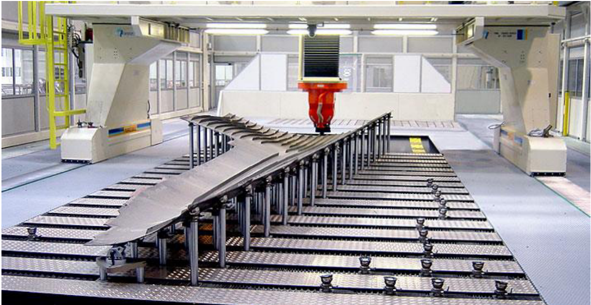
Abbildung 31: Bearbeitungszentrum TORRESMILL® mit Spannsystem TORRESTOOL® [15]
