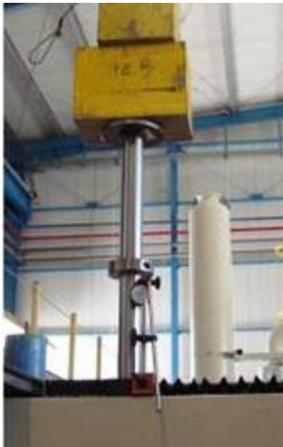
Abbildung 23: Steifigkeitsmessung TORRESTOOL Gesamtaufbau [12]
