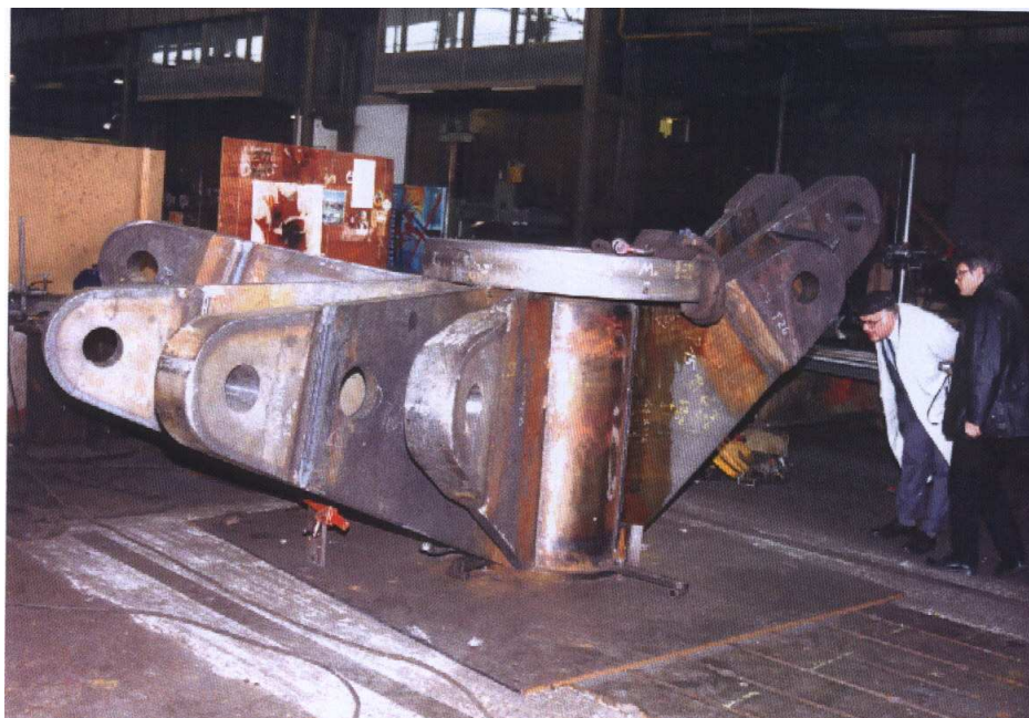
Abb.6.2: Rendering und Werkstück des Knotens vom Forumdach des Sony Centers; aus /13/
