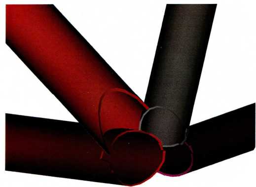
Abb.15.16: Computermodell eines Knotens mit Anschlussblechen; aus /14/
