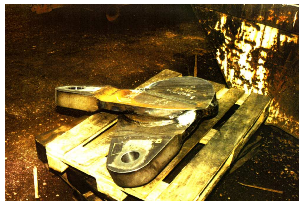
Abb.15.18: Ausführung eines Anschlussbleches; aus /14/
