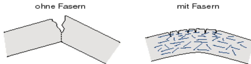
Abbildung 7: Rissbremsende und -verteilende Wirkung von Fasern; [6]
