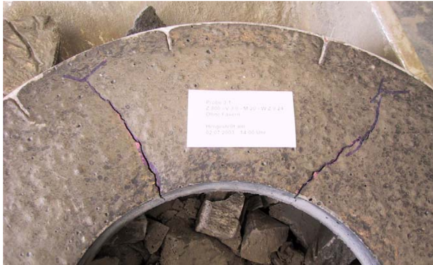
Abbildung 88: Probe P 0 (4) – max. Rissbreiten über 1 mm
