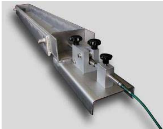
Abbildung 46: Schleibinger Schwindrinne mit Stempel, Lagerbock, Geberaufnahme; [20]
