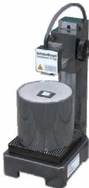
Abbildung 51: Schleibinger Schwindkegel Model: deltaEL; [20]
