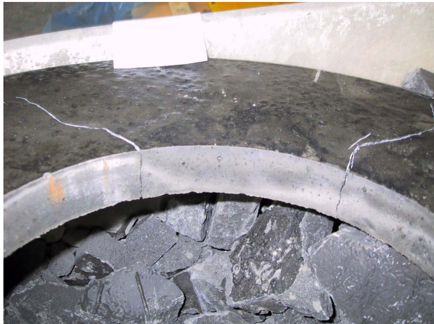
Abbildung 82: Durchgerissene Probe P 0 (3) ohne PP-Fasern
