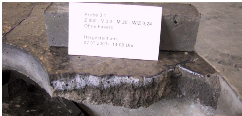
Abbildung 89: Sehr stark ausgetrocknete obere Schicht (weißer Rand)
