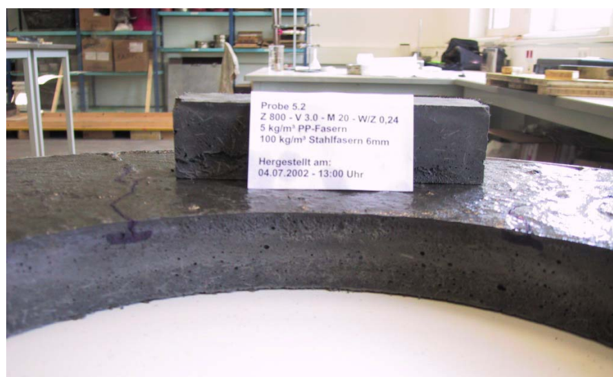
Abbildung 83: Risstiefe der Probe P 5 (1) mit 5 \text{ kg/m}^3 PP-Fasern
