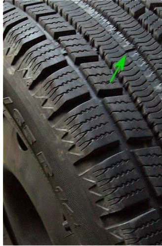
Abb. 5-11 Leichte Verschleißerkennung am Beispiel Autoreifen
