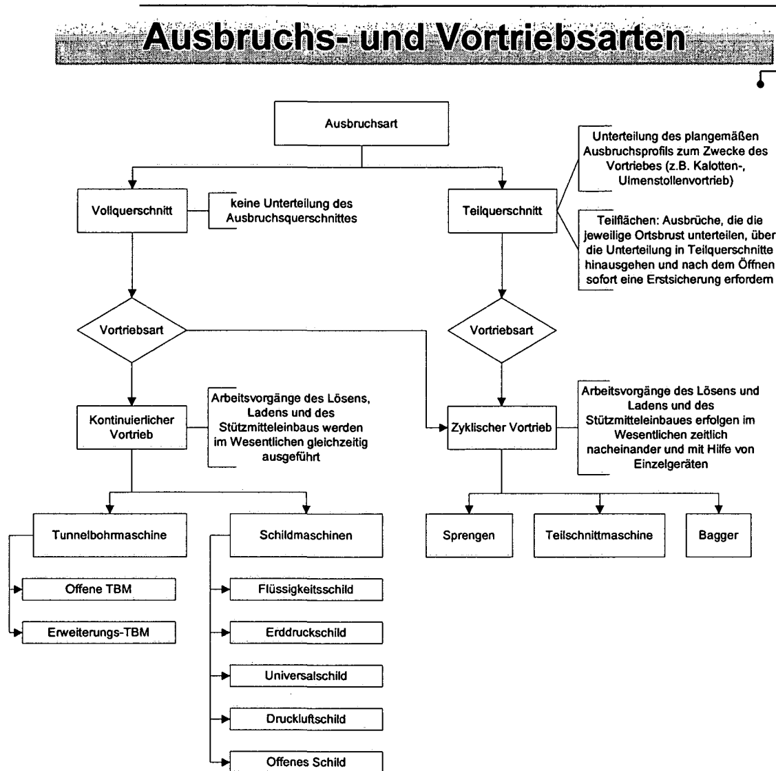
Abbildung 38: Überblick über Ausbruchs- und Vortriebsarten im Tunnelbau
