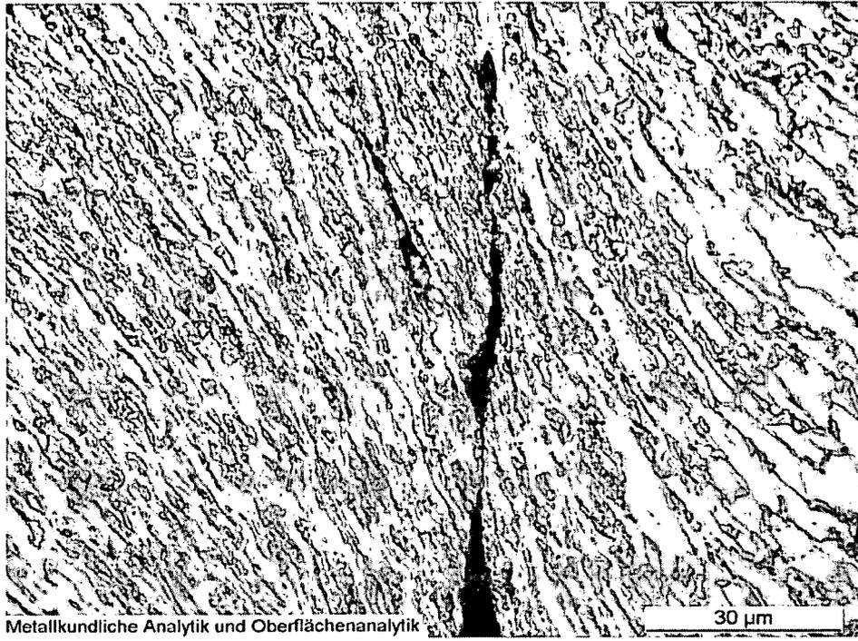
**Fig. 6.14** Offener gerader Schnitt an H300X; starke Vergrößerung bei Rissbeginn
