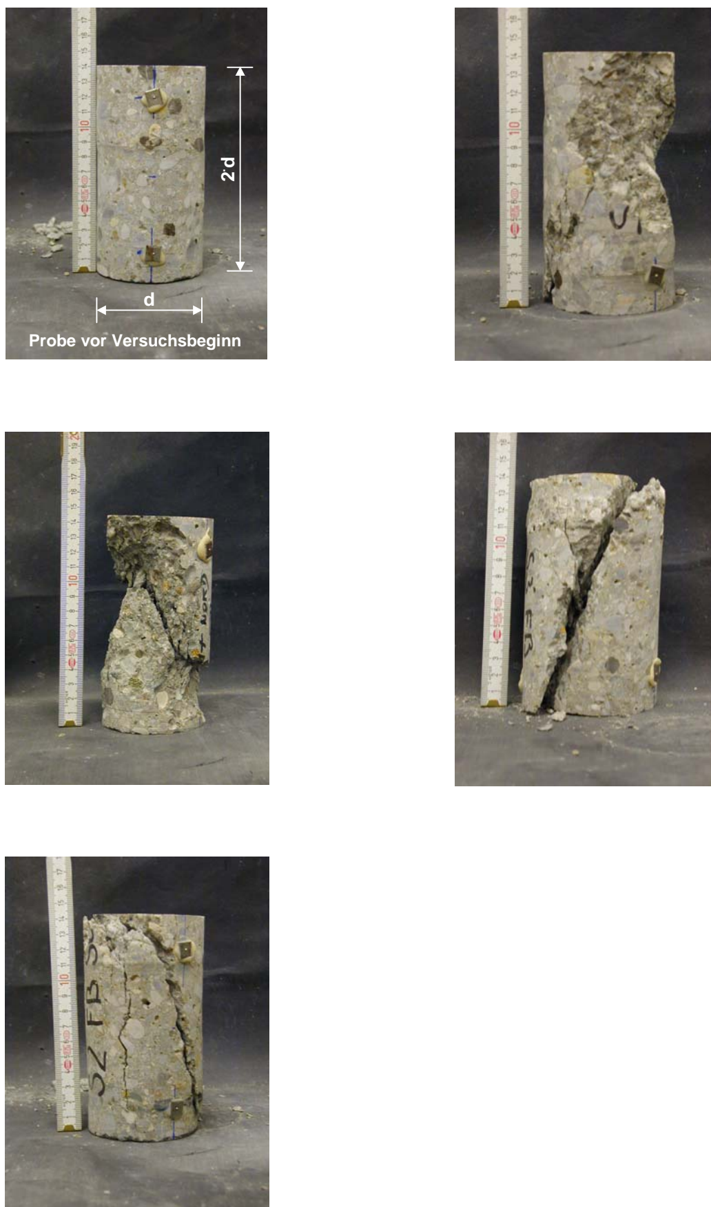
Bild 4.16 Bruchbilder der Bohrkernbeim Druckversuch
