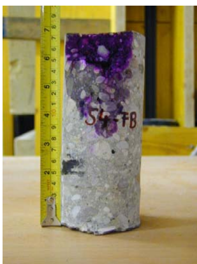
Bild 4.14 Überprüfung der Karbonatisierung an Bohrkernen
