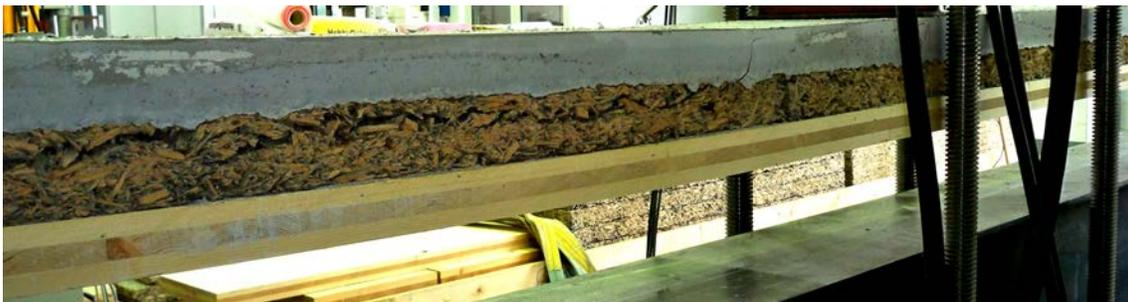
Abbildung 4.34: Verlauf des Schubrisses bei Großversuch G1
