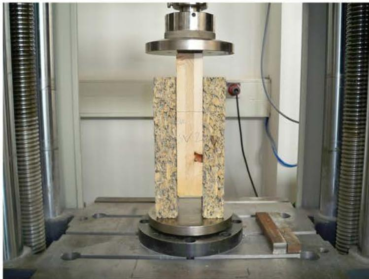
Abbildung 3.17: Eingebauter Probekörper (Scherversuch CLT-Velox) in der Prüfmaschine
