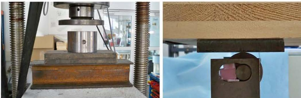
Abbildung 4.6: Stempel zur Kraftaufbringung und Rollenlager
