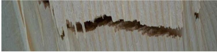
Abbildung 4.30: Biegezugriss im Holz (Versuch 6.1)
