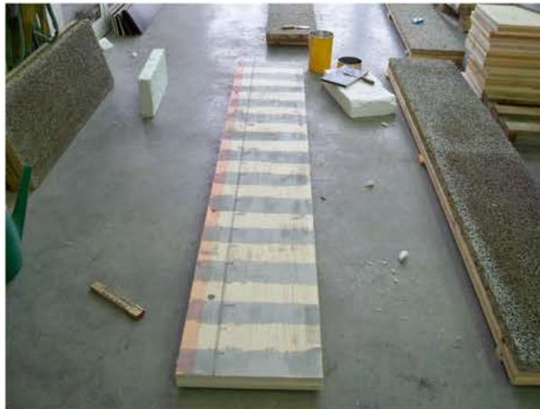
Abbildung 4.2: Aufgeklebte Kunststoffgittermatte des Versuchsaufbaus 4
