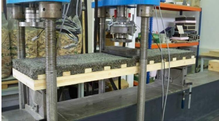
Abbildung 3.10: Eingebauter Probekörper (CLT-Holzbeton Aufbau) in der Prüfmaschine [19]
