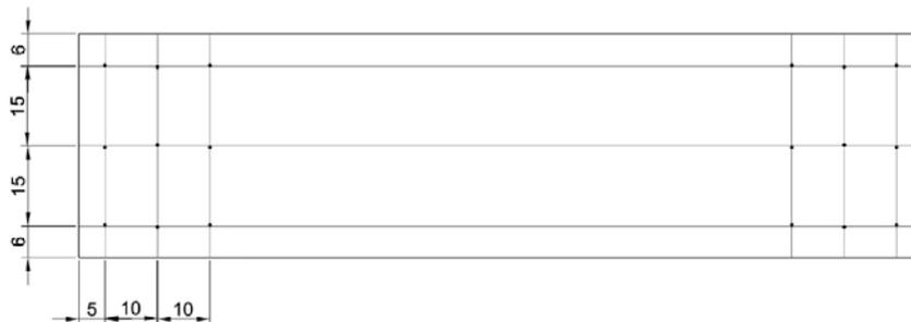
Abbildung 3.11: Verschraubungsplan zu dem Plattenversuch CLT-Velox-SVB [19]
