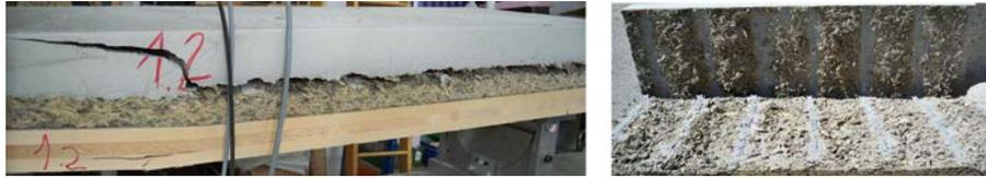
Abbildung 4.23: horizontaler Riss in der *Veloxplatte* links und resultierende Scherfläche rechts (Versuch 1.2)
