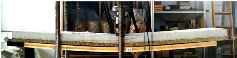
Abbildung 6.1: 3-Punkt Biegeversuch eines 3-schichtigen Holz-Holzbeton-Beton Verbundquerschnittes
