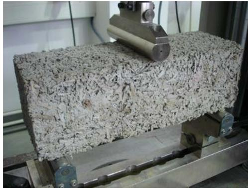
Abbildung 3.2: Prüfung der Biegezugfestigkeit eines Holzbetonprismas [19]
