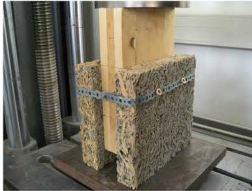
Abbildung 3.19: Scherversuch (CLT-Velox) mit Klemmband
