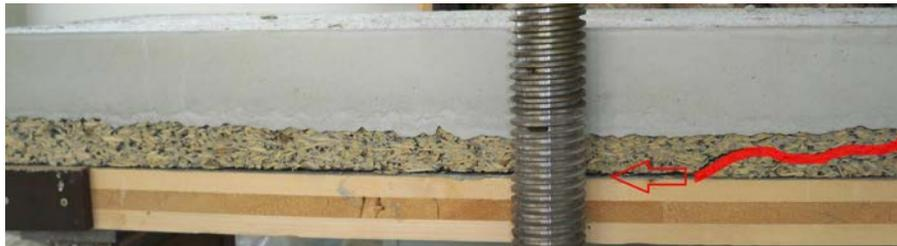
Abbildung 4.27: linke Plattenhälfte des Versuchs 5.1 mit eingezeichneten Riss und aufgeganger Verbundfuge
