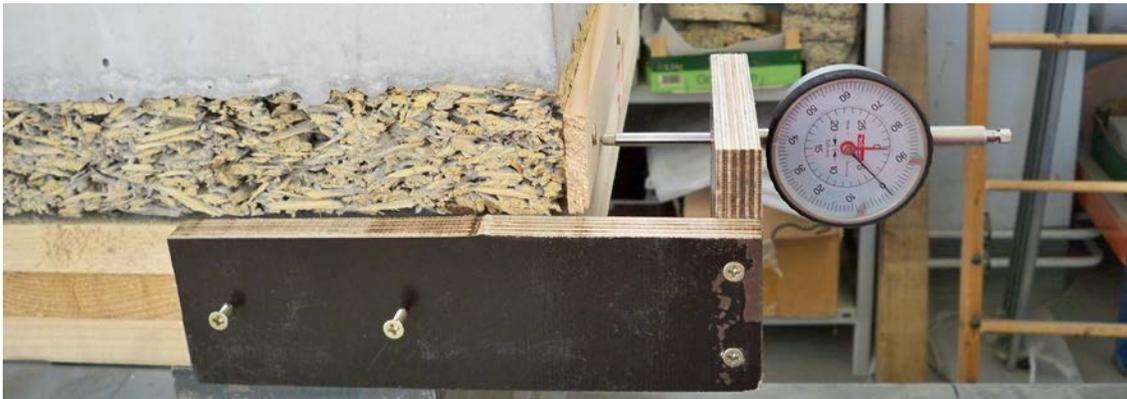
Abbildung 4.7: montierte Messuhr zur Messung der Horizontalverschiebungen in der Verbundfuge
