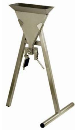
Abbildung 2.5: Auslauftrichter zur Bestimmung der Auslaufzeit [23]
