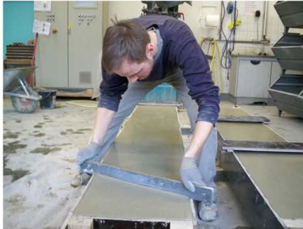
Abbildung 4.4: Abziehen des überflüssigen Betons mit einem Abziehbrett
