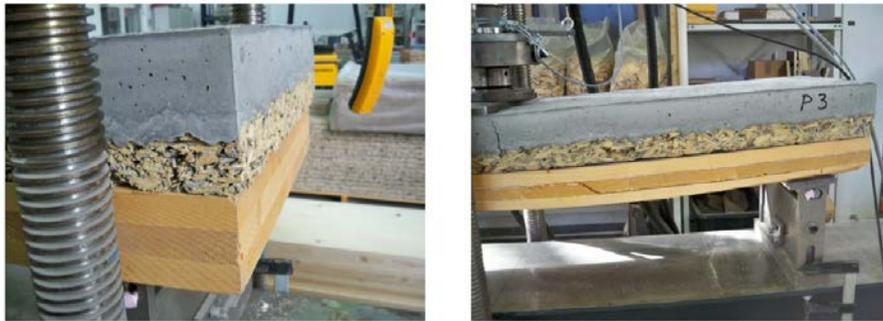
Abbildung 3.12: Horizontalverschiebung in der unteren Verbundfuge und rechte Trägerhälfte kurz vor Erreichen der Traglast [19]
