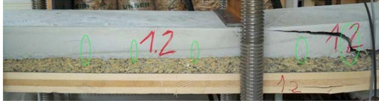
Abbildung 4.25: Betonrisse in der Betonschicht im Feldmittenbereich (Versuch 1.2)
