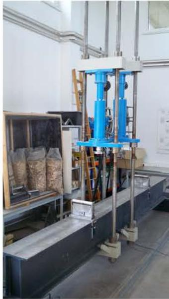
Abbildung 4.5: Prüfmaschine für den 3-Punktbiegeversuch
