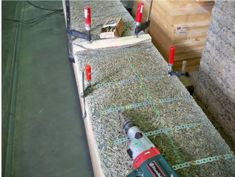
Abbildung 4.1: Montage der Verbindungsmittel bei Probekörper 1.1
