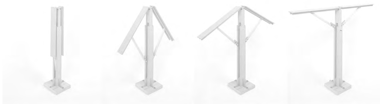
Abb. 5.3: Klappvorgang anhand des Druckstrebenmodells [52]
