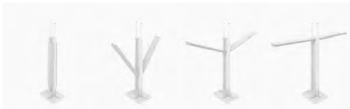
Abb. 5.4: Klappvorgang anhand des Zugstrebenmodells [52]
