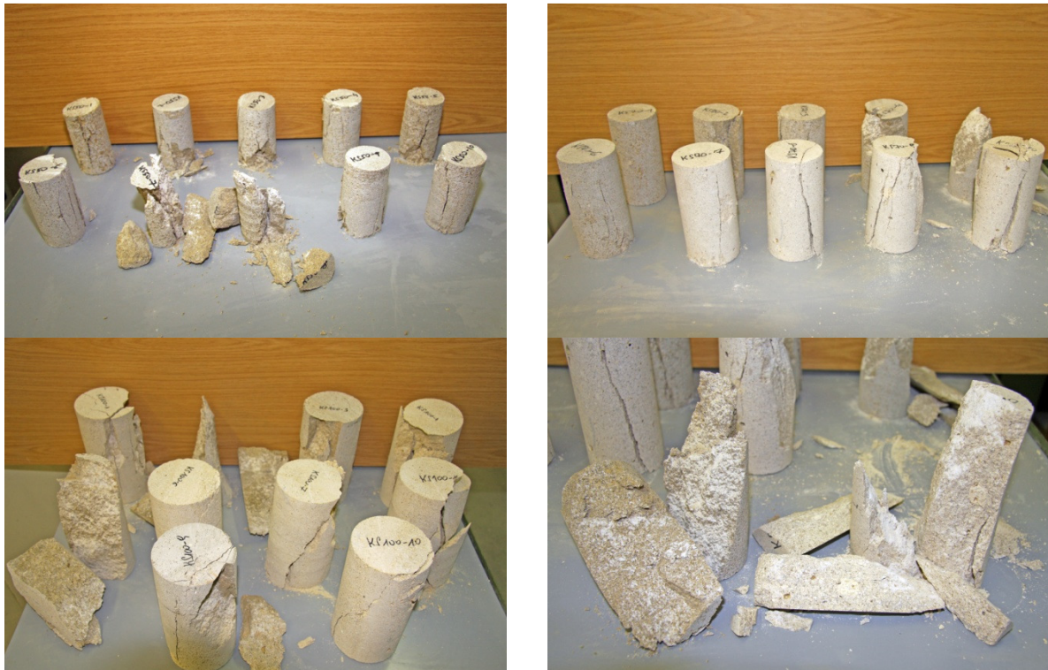
Abbildung 83: 1. Reihe: KS50, KS70; 2. Reihe: KS100, Scherbruch KS70-2(links) und Spaltbruch KS70-10(rechts)
