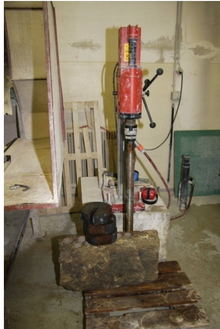
Abbildung 33: Herstellung eines Ø70 mm Bohrkerns aus dem Leithakalkblock aus Kaisersteinbruch Nr. IV
