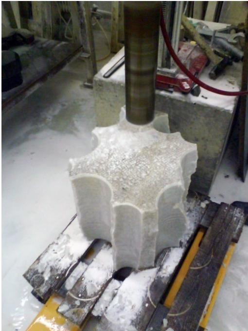
Abbildung 32: Herstellung eines Ø100 mm Bohrkerns aus Sterzinger Marmor
