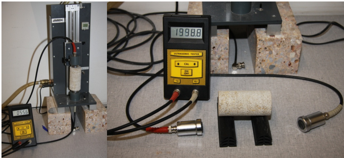
Abbildung 46: Ultraschallmessung eines Leithakalkprüfkörpers mittels Druckluftstativ und im "Feld"
