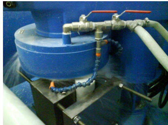
Abbildung 35: Schleifen einer abgelängten Sterzinger Marmorprobe
