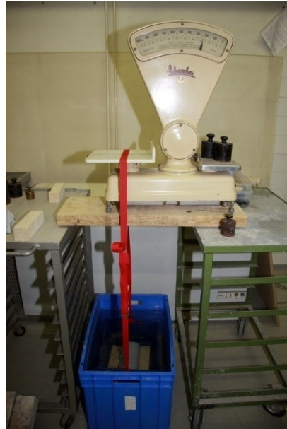
Abbildung 40: Schemper Tafelwaage mit selbstgebauter Einrichtung zur Messung der Masse unter Auftrieb
