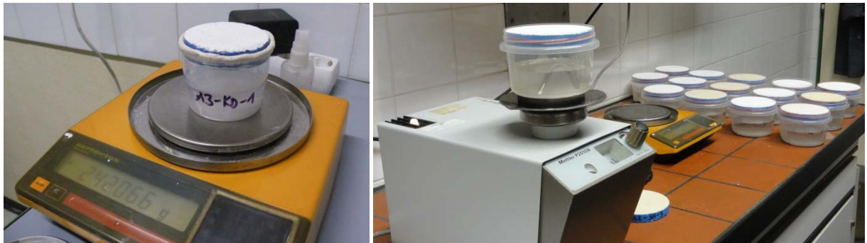
Abbildung 5-6: Versuchsaufbau Wasserdampfdiffusion Li: Versuchsreihe A, Re: Versuchsreihe B
