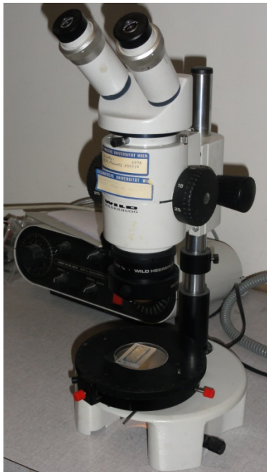
Abbildung 5-8: Versuchsaufbau dünnschliffmikroskopische Untersuchungen im Auflichtmikroskop
