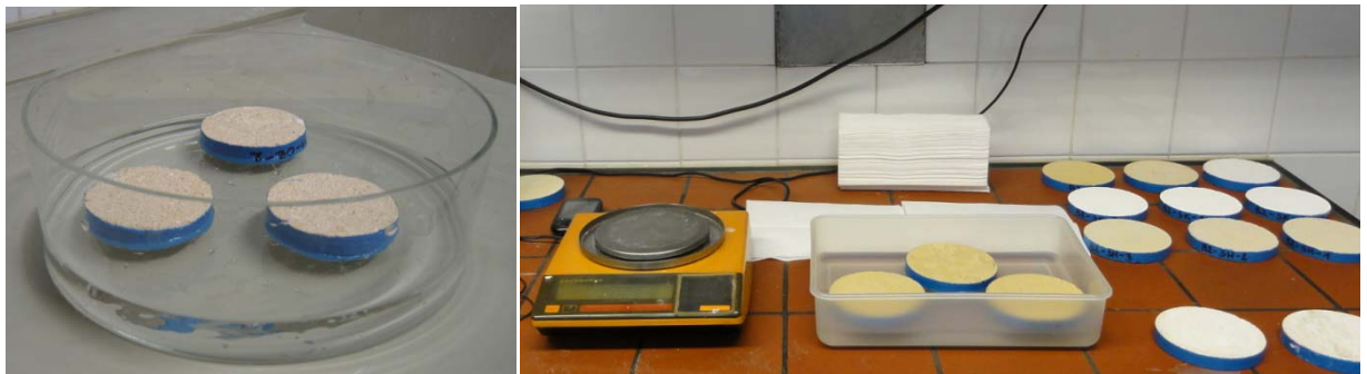
Abbildung 5-2: Versuchsaufbau Wasseraufnahme. Li: Versuchsreihe A, Re: Versuchsreihe B
