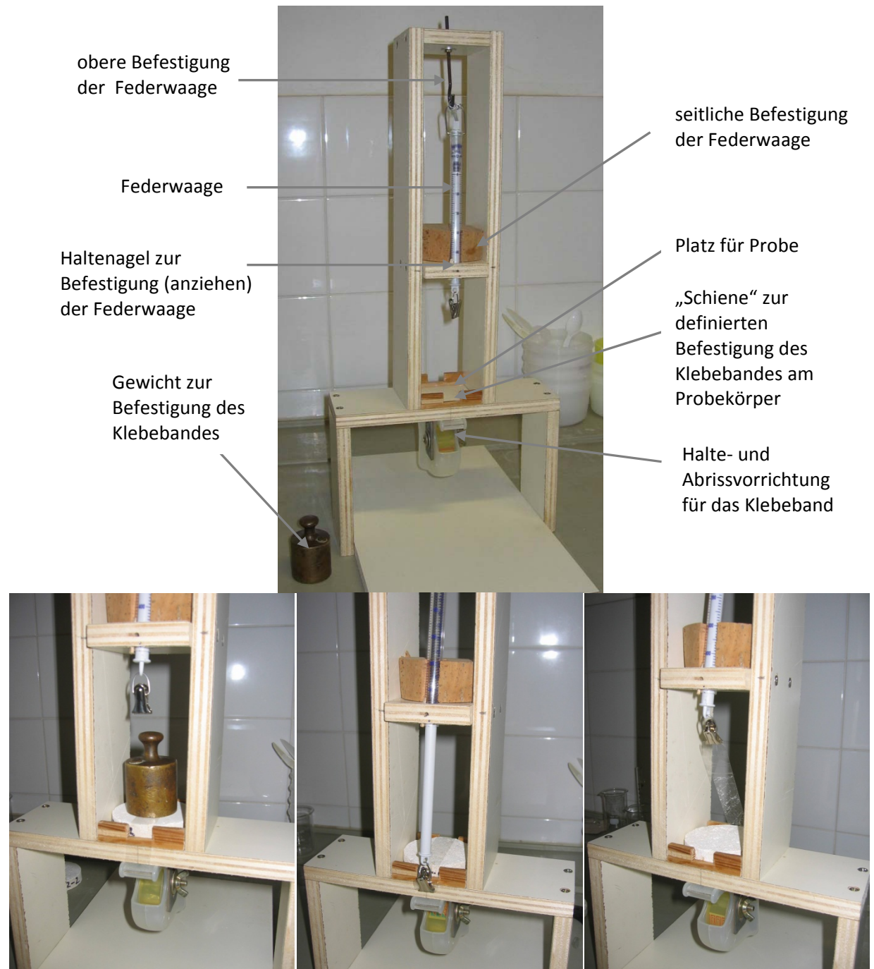
Abbildung 5-7: Versuchsablauf Schälwiderstandsprüfung von links nach rechts: 1. Aufbringen des Klebestreifens am Probekörper und Befestigung mittels Gewicht 2. „Anziehen“ der Federwaage und Befestigung am Klebestreifen, Fixierung der Federwaage mit Hilfe eines Nagels 3. Abziehen des Klebestreifens (durch Entfernen des Nagels) 234
