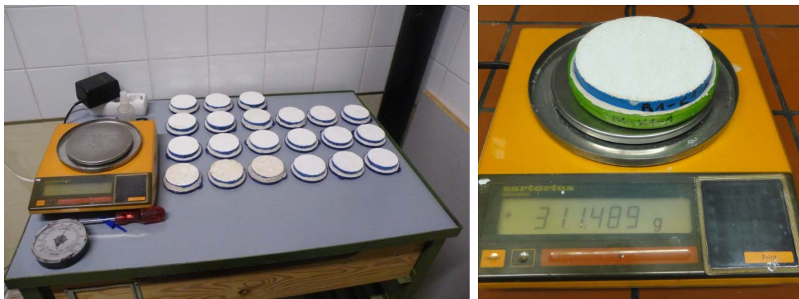
Abbildung 5-4: Versuchsaufbau Wasserabgabe Li: Versuchsreihe A, Re: Versuchsreihe B
