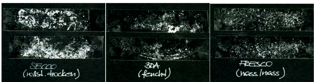
Abbildung 4-9: Klebestreifen mit Abrieb der Kalkbeschichtung nach Peeling-Test (Links: als secco (nass auf trocken), Mitte: al fresco 2 (nass in feucht), Rechts: al fresco 1 (nass in nass)).
