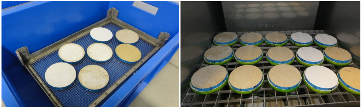
Abbildung 5-10: kapillare Sättigung der Proben mit Wasser bzw. Salzlösung (li), Lagerung der Proben im Klimaschrank (re)
