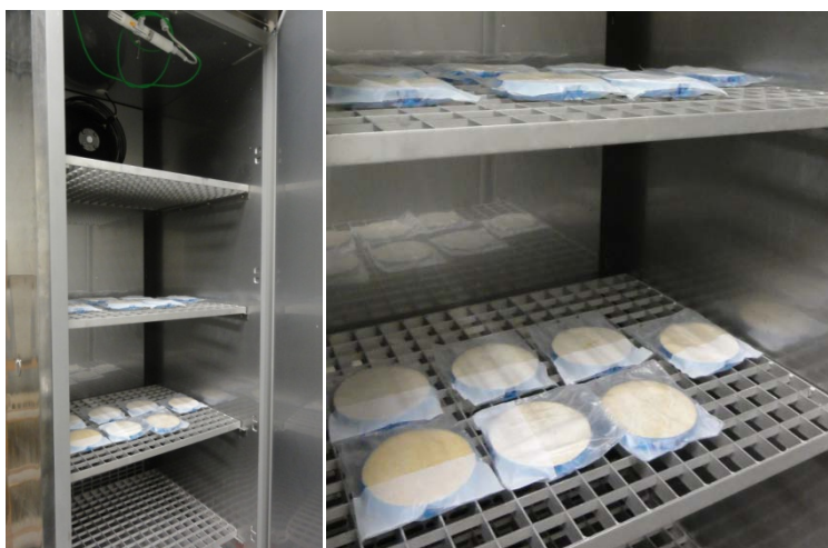
Abbildung 5-12: Lagerung der vakuumverschweißten Proben im Klimaschrank
