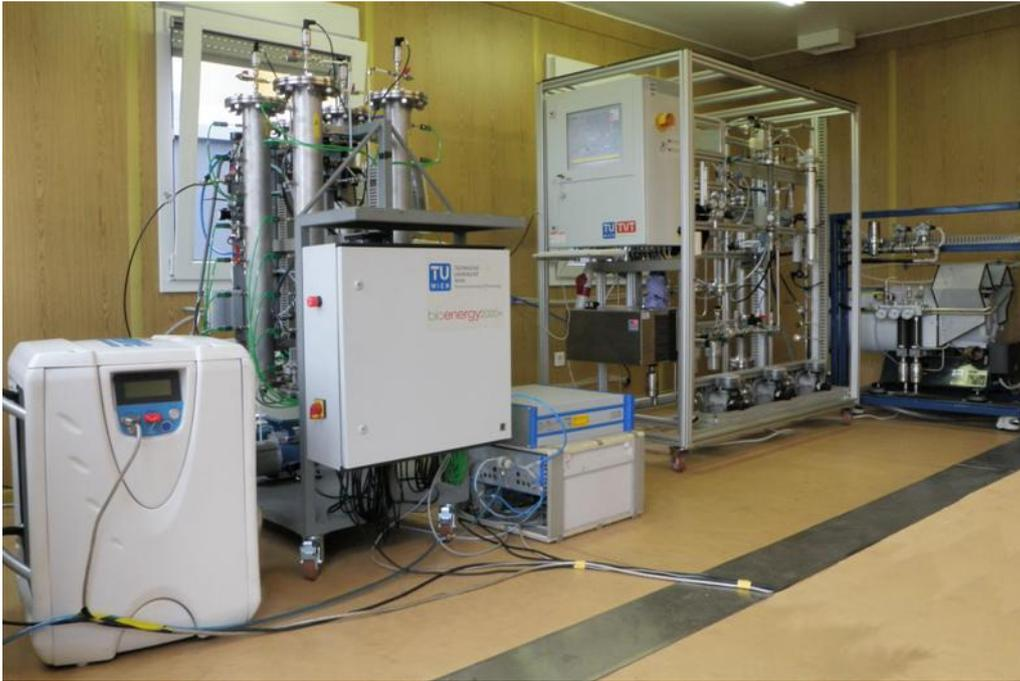
Abbildung 6.6: Photo der Prozesskette zur Gewinnung von Wasserstoff aus Synthesegas
