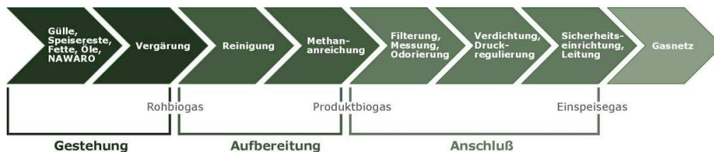
Abbildung 4.4: Verfahrensschritte der Biogasaufbereitung, [55]
