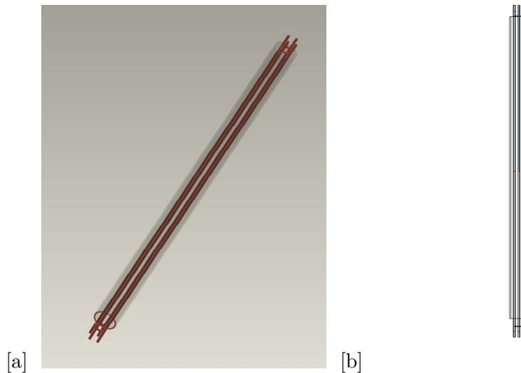
Abbildung 5.24: 3D-Darstellung [a] und schematische Darstellung [b] des im Adsorber integrierten Rohrbündelwärmetauschers
