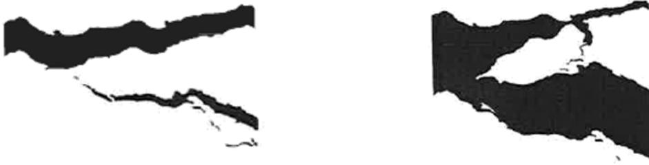
Abbildung 22: Optische Aufnahme der Stadien der Rissöffnung mit Rissverzweigung [MIER 91]
