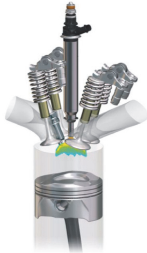
Abbildung 2.3: Brennraumschnitt des M276 - Motors mit zentraler Injektorlage [15]
