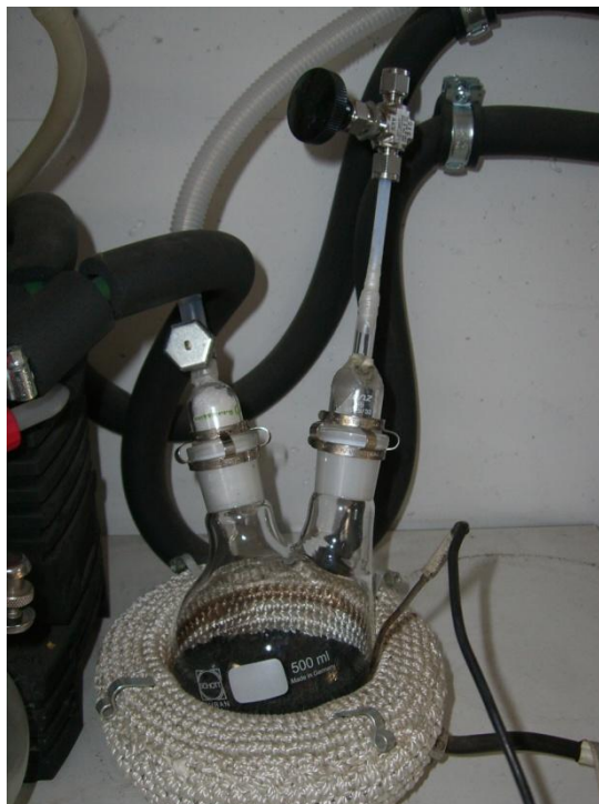
Abbildung 3-14 Desorptionsversuche mit Vakuum und Leckluftstrom über Nadelventil
