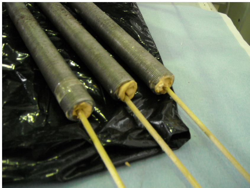
Abbildung 22: In Gewindestangen eingeklebte Aramidstangen
