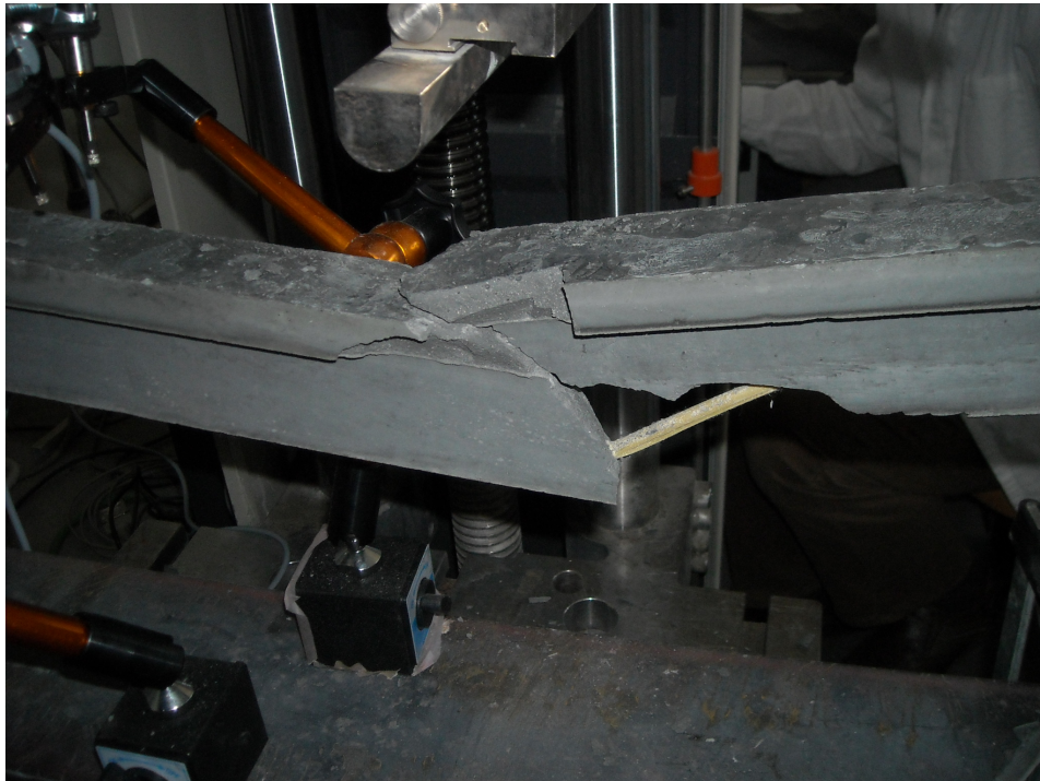
Abbildung 67: Schubbruch eines Plattenbalkens
