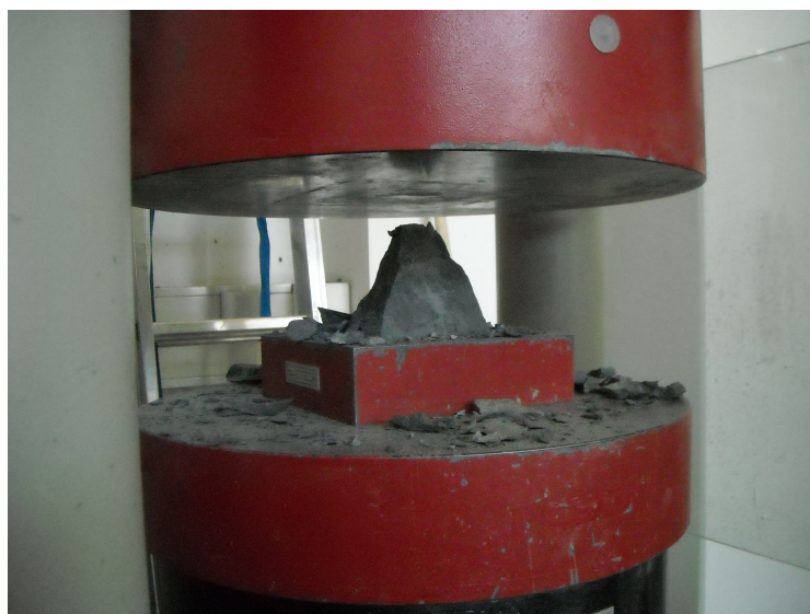
Abbildung 31: Bruchbild eines zerstörten Betonwürfels
