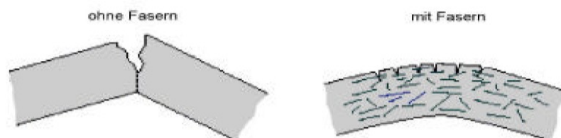
Abbildung 7: Rissverteilung durch Fasern im Beton [16]
