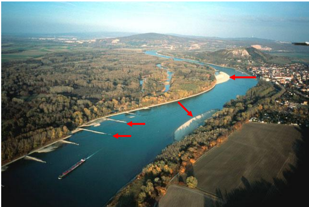
Abbildung 7.2: Verengung des Fließquerschnitts der Donau durch Buhnen und Steininseln östlich von Wien [DBU12].
