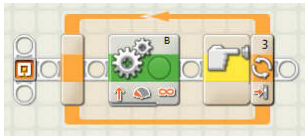
Abb. 6.13: Lösung 6 – Roboter mit einem Berührungssensor fernsteuern
