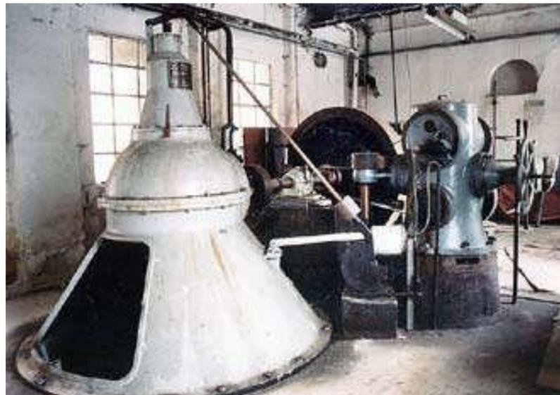
Abb. 113 Vertikale Kaplanturbine werkseigenen Wasserkraftwerk
