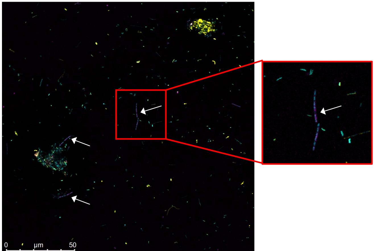
Abbildung 5: Fluoreszenzmikroskopische Aufnahme einer FISH-Analyse von einer Faulbehälterprobe. Die Abbildung ist eine Überlagerung verschiedener parallel erstellter Aufnahmen von stoffwechselaktiven Bakterien (gelb) und methanbildenden Archaea (magenta). Alle Zellen wurden mit dem DNS-bindenden Fluoreszenzfarbstoff DAPI (hellblau) markiert. Mit den weißen Pfeilen sind einige der methanbildenden Archaea markiert (*Quelle: E. Nettmann, A. Rademacher; RUB*).
