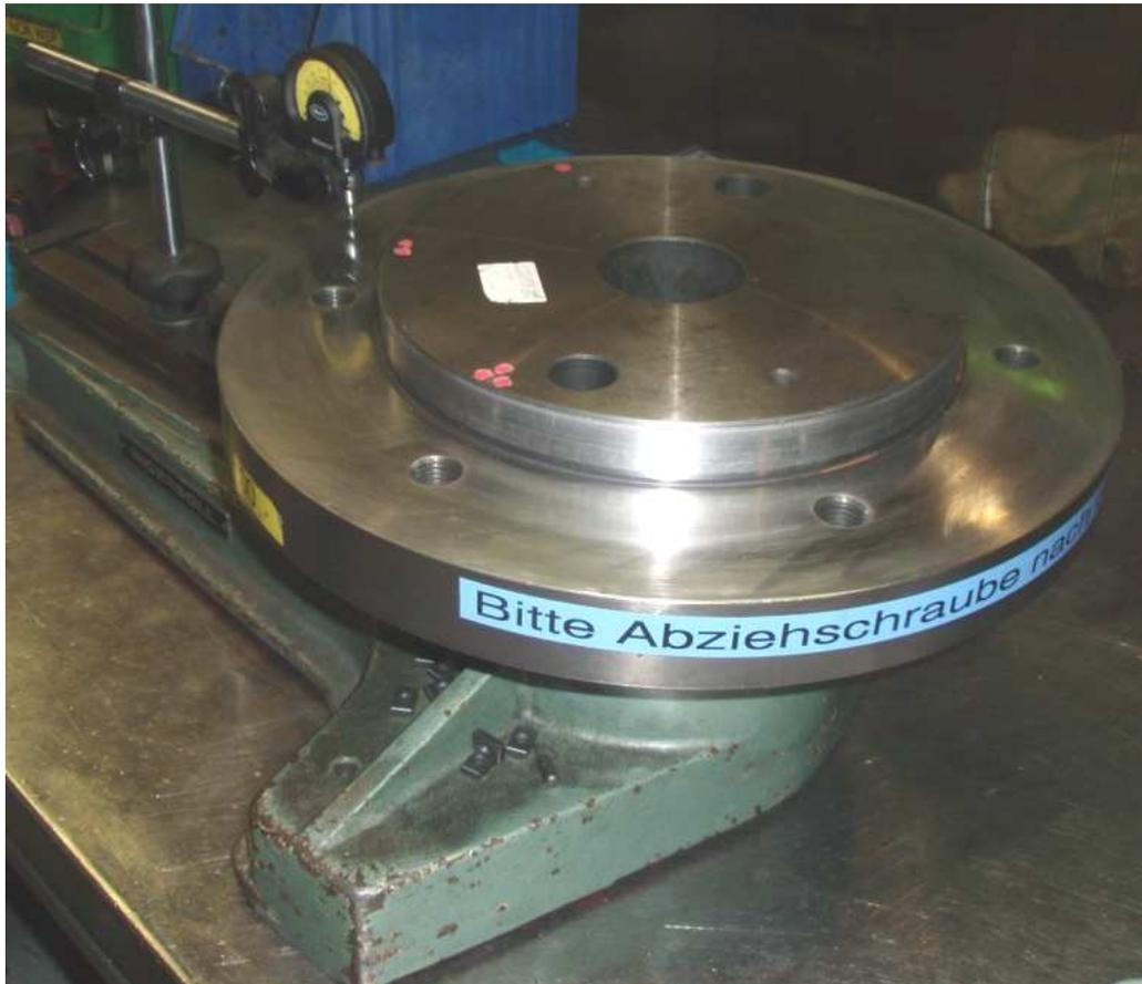
Abbildung 4-1: Messvorrichtung und Messuhr
