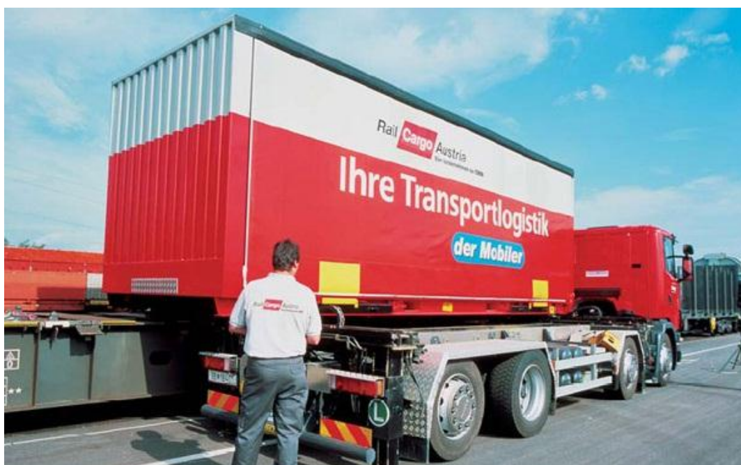
Abbildung 22: Horizontaler Umschlag mit dem Mobiler (Verkehrsrundschau (2), 14.05.2012)
