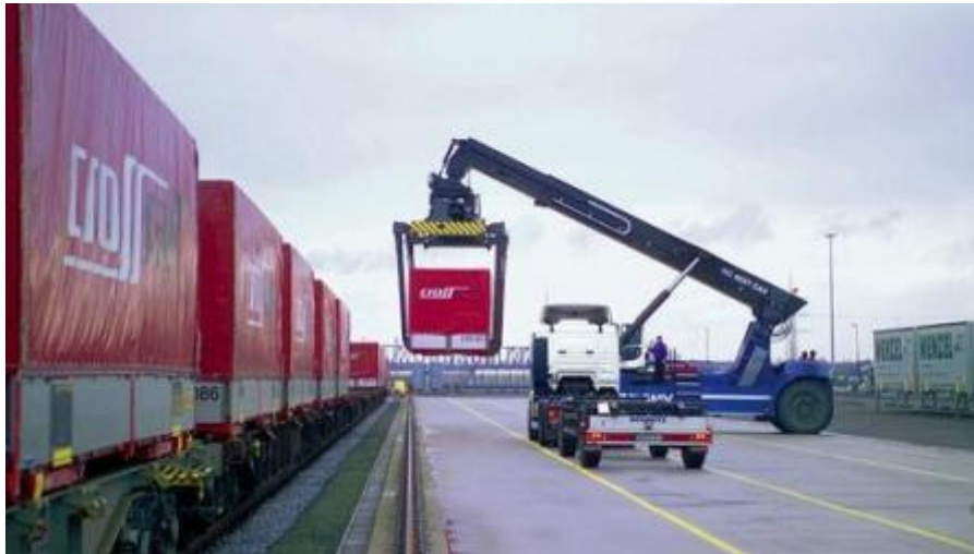
Abbildung 10: Huckepackverkehr mit Wechselaufbauten (Atenta, 09.05.2012)
