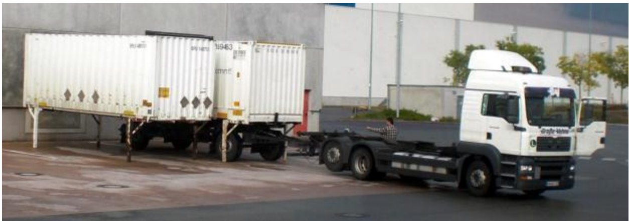
Abbildung 15: Beladevorgang eines Wechselaufbaus (Wikimedia, 12.05.2012)
