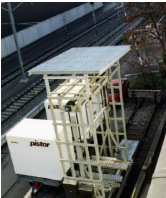
Abbildung 66: horizontaler Umschlag von Combi-Boxen (Stadt Zürich, 25.09.2012, S.2)
