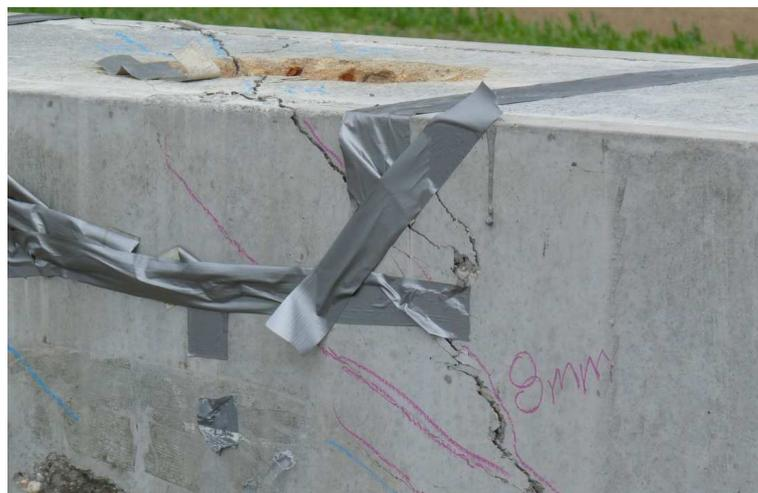
Abbildung 138: Versagensstelle in der rechten Versuchsträgerhälfte
