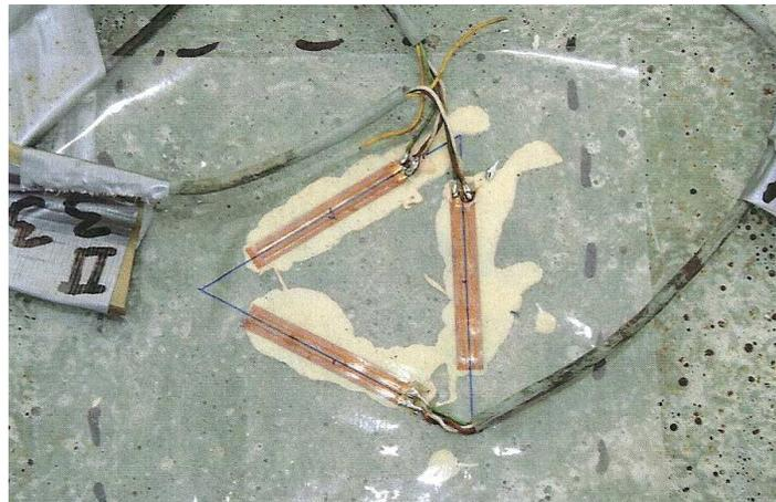
Abbildung 114: Anordnung der DMS als gleichseitiges Dreieck
