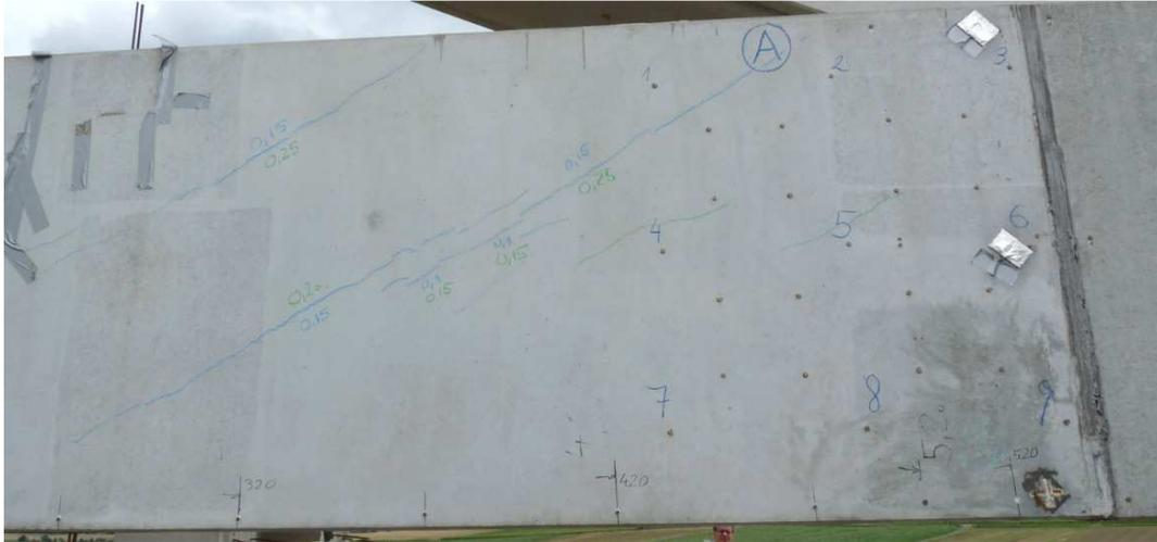
Abbildung 131: Risse in der Vorderseite der linken Versuchsträgerhälfte - Laststufe 1.075 kNm nach 115 Minuten
