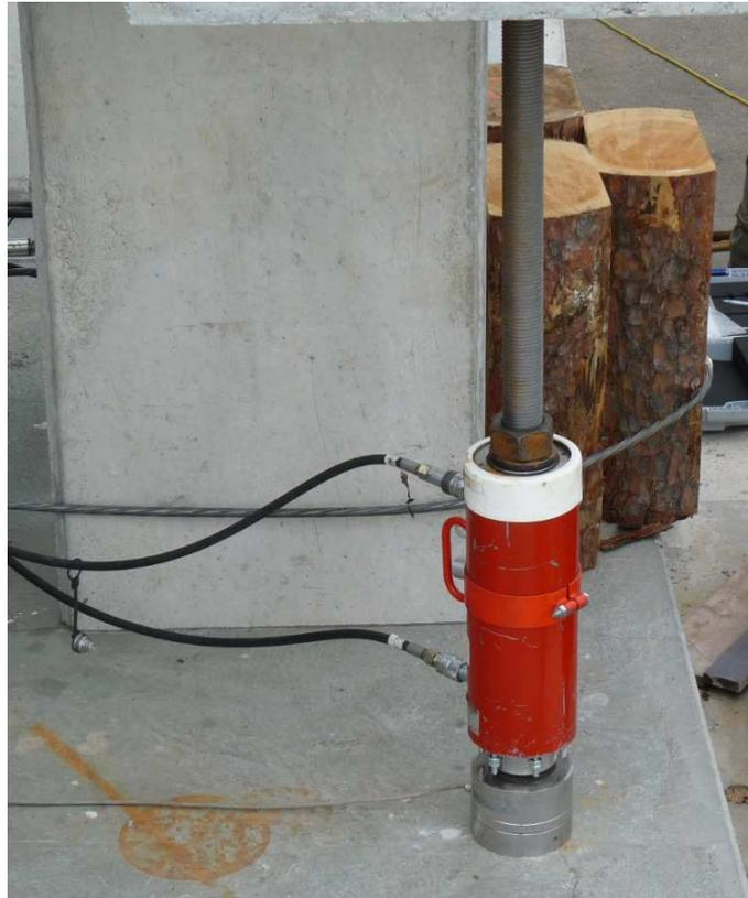
Abbildung 95: Kraftmessdose unter der Presse
