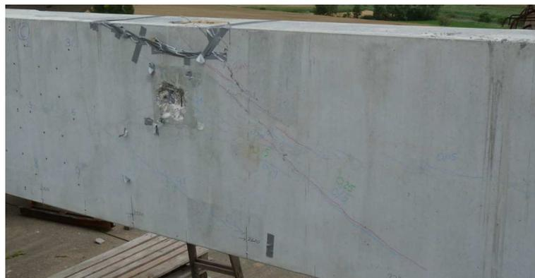
Abbildung 137: Risse in der Vorderseite der rechten Versuchsträgerhälfte - Laststufe 1.290 kNm
