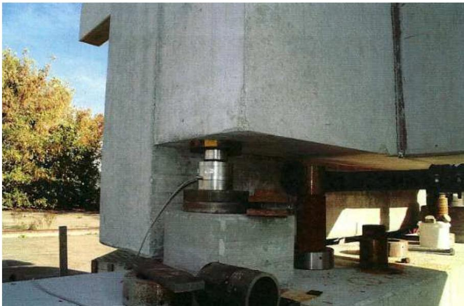
Abbildung 90: Kraftmessdosen zur Bestimmung der Auflagerreaktionen [4]
