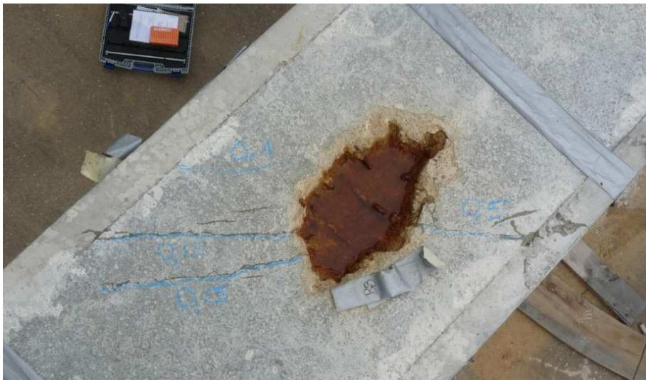
Abbildung 128: Risse in der Oberseite der rechten Versuchsträgerhälfte - Laststufe 1.075 kNm
