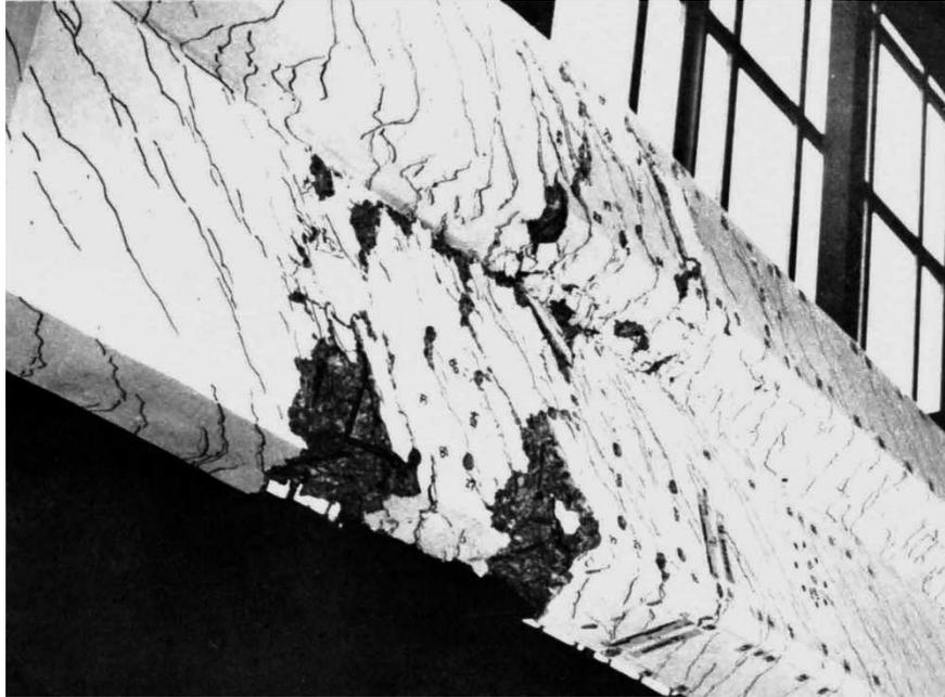
Abbildung 55: Ankündigung des Bruchs des Versuchsbalkens  $T_6$  [12]
