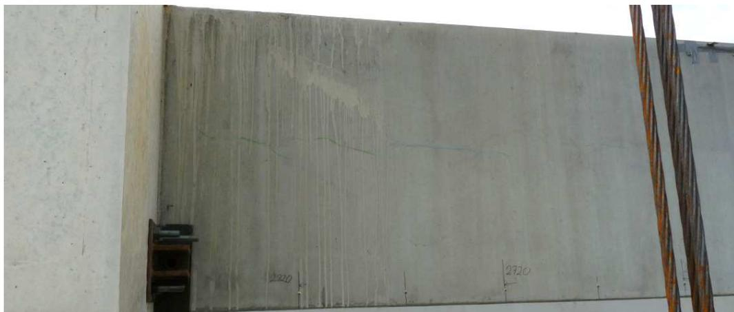
Abbildung 133: Risse in der Hinterseite der rechten Versuchsträgerhälfte - Laststufe 1.075 kNm nach 115 Minuten
