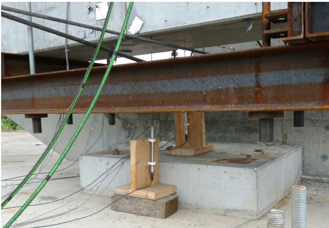
Abbildung 142: Wegaufnehmer an der Unterseite des Versuchsträgers
