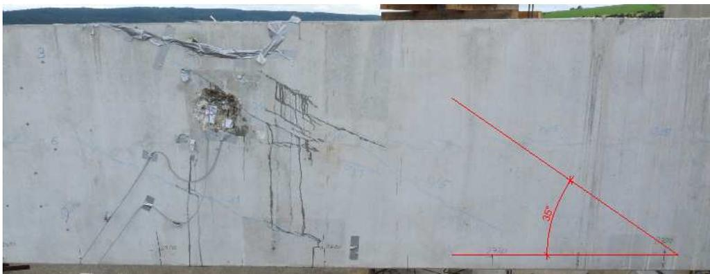
Abbildung 126: Risse in der Vorderseite der rechten Versuchsträgerhälfte - Laststufe 1.075 kNm
