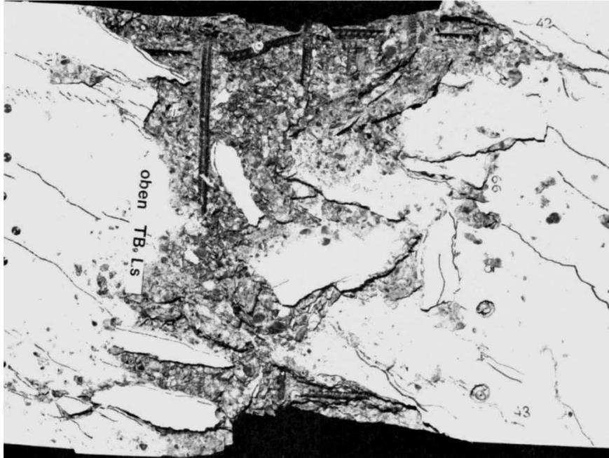
Abbildung 60: Bruchbereich des Versuchsbalkens TB<sub>9</sub> [12]
