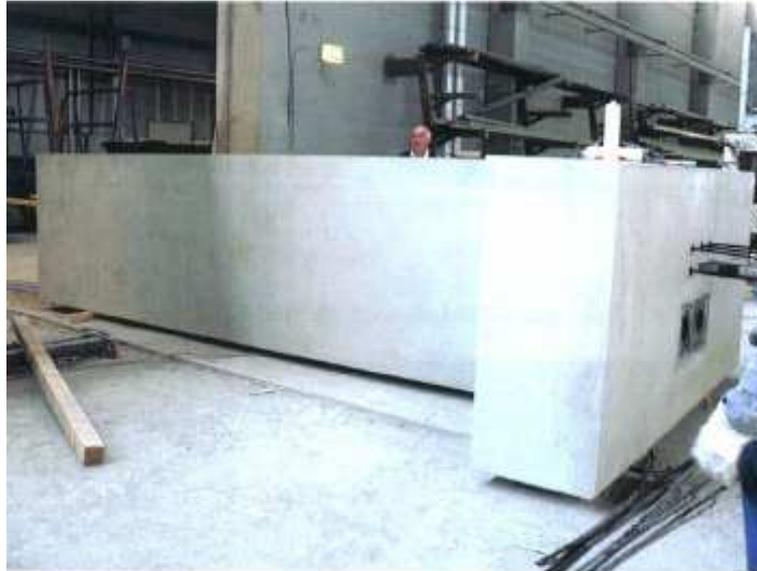
Abbildung 88: Der zusammengefügte Trägerendteil [4]
