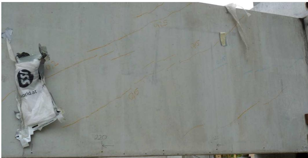
Abbildung 135: Risse in der Hinterseite der linken Versuchsträgerhälfte - Laststufe 1.290 kNm
