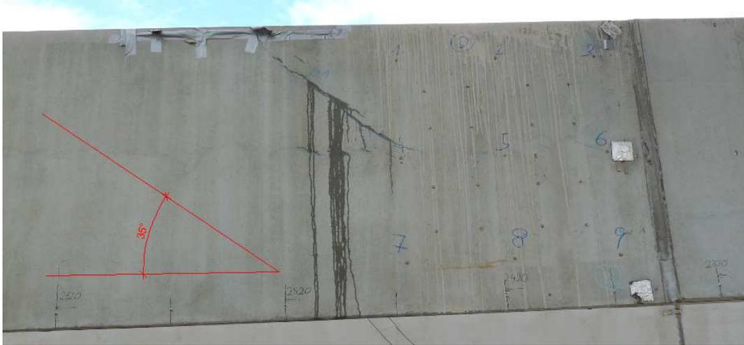
Abbildung 127: Risse in der Hinterseite der rechten Versuchsträgerhälfte - Laststufe 1.075 kNm
