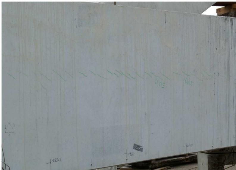
Abbildung 132: Risse in der Vorderseite der rechten Versuchsträgerhälfte - Laststufe 1.075 kNm nach 115 Minuten
