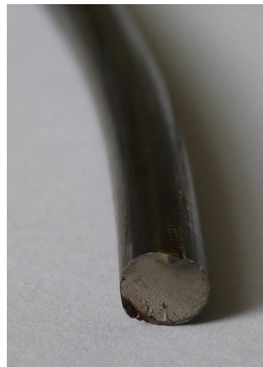
Abbildung 8-3 Ermüdungsbruch a) Interaktion Keil/ Außendraht b) Detail Außendraht (Monosystem)
