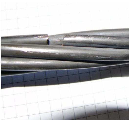
Abbildung 8-3 Ermüdungsbruch a) Interaktion Keil/ Außendraht b) Detail Außendraht (Monosystem)
