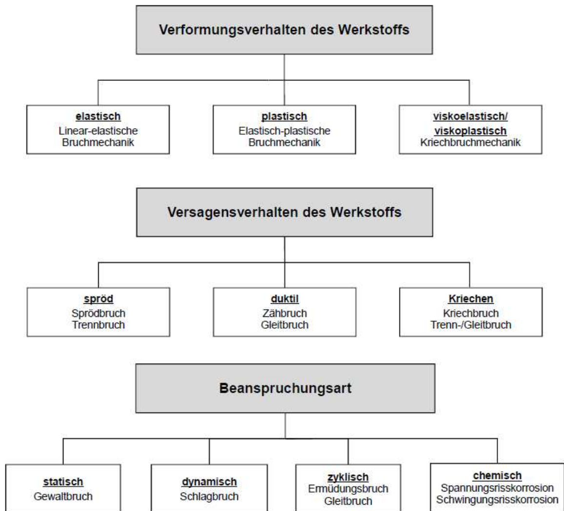
Abb. 26: Klassifikation der Bruchvorgänge nach [26]
