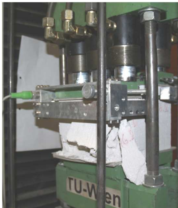
Abb. 84: Zerstörter Probekörper bei Vorspannung durch die hydraulischen Pressen mit 60 % der Druckfestigkeit
