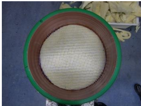
Abb. 27: Rückseite des Prüfgefäßes 3 mit eingebauter Dämmung
