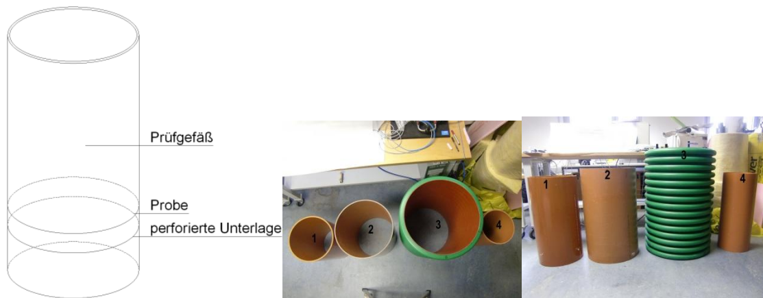
Abb. 25: Draufsicht und Ansicht der Prüfgefäße 1 bis 4
