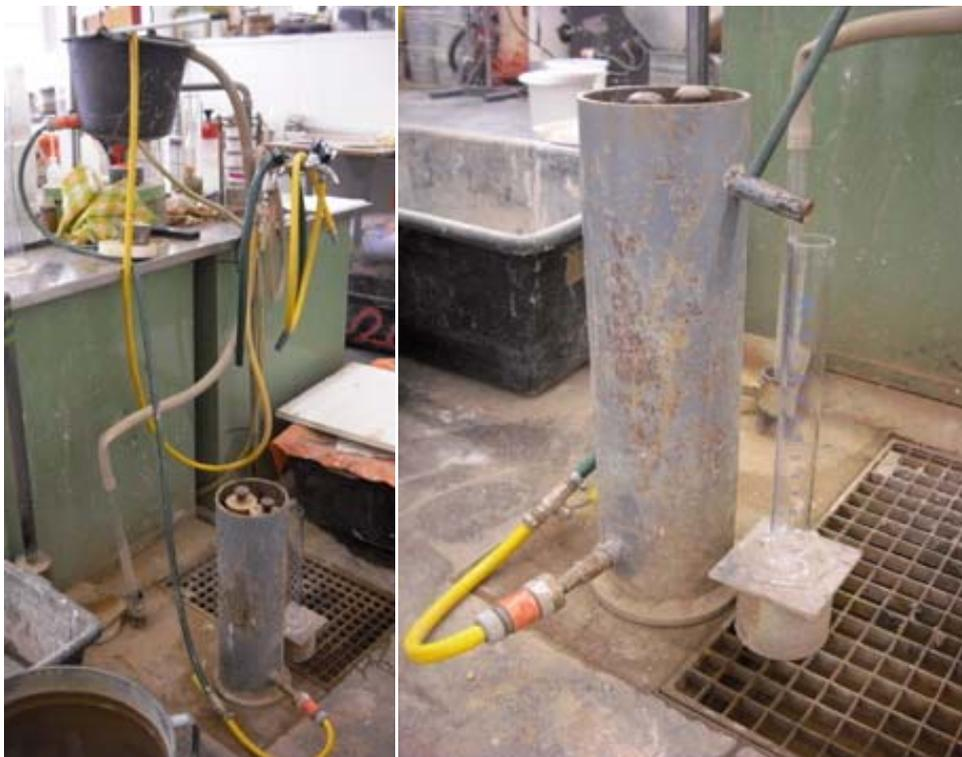
Abb. 3.18: Ermittlung der Wasserdurchlässigkeit mit konstanter Druckhöhe
