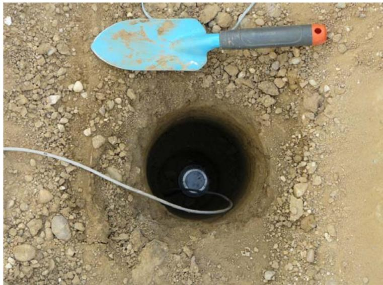
**Abb. 3.37: Durchbohrte Deckschicht mit installiertem Porenwasserdruckgeber.**
