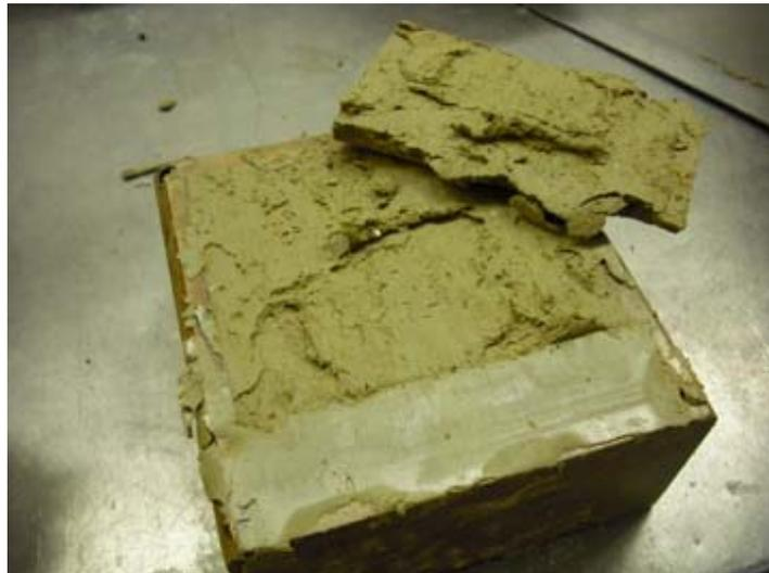
Abb. 3.15: Bodenprobe nach dem Wiener Routinescherversuch
