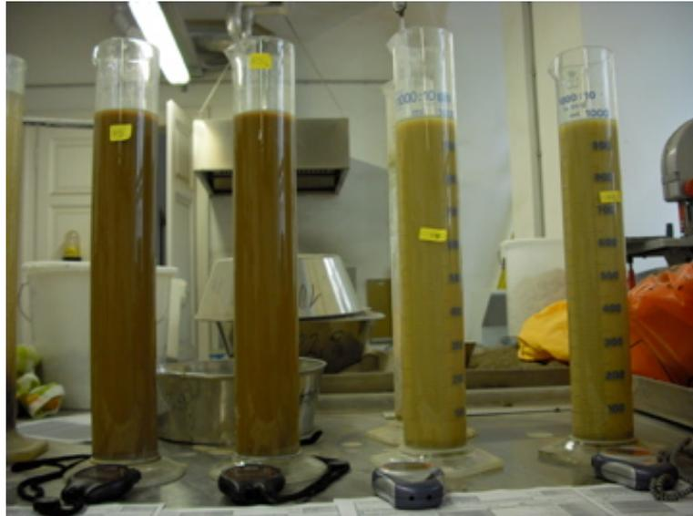
Abb. 3.9: Schlämmanalyse zur Ermittlung der Korngrößenverteilung im Feinkornbereich
