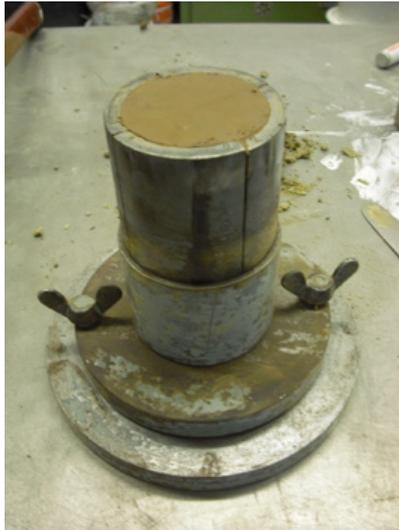
**Abb. 3.21: Proctortopf Olympia zur Bestimmung der einfachen Proctordichte**
