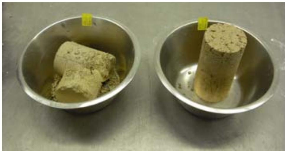
**Abb. 3.22: Einzelproben eines Proctorversuchs im Anschluss an die Trocknung bis zur Massekonstanz**
