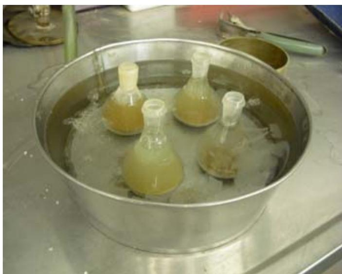
**Abb. 3.8: Kapillarpyknometer in der Abkühlphase**
