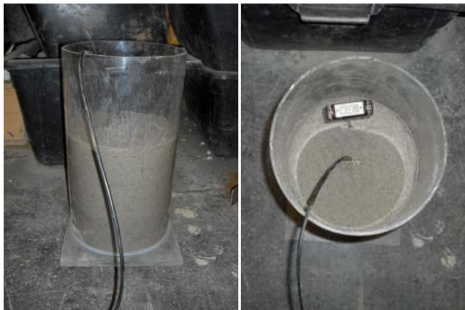
**Abb. 3.51: Zylinder zur Kalibrierung der Feuchtesensoren im Labor**
