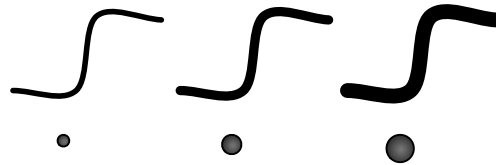
Abbildung 5.12: Kabel- und Anschlussstärken. Für einfache Datenfelder wird ein dünnes Kabel verwendet (links), für komplexere Datenstrukturen ein etwas dickeres (Mitte) und für die Zusammenfassung aller Output-Daten eines Tasks oder Proxys das dickste (rechts).
